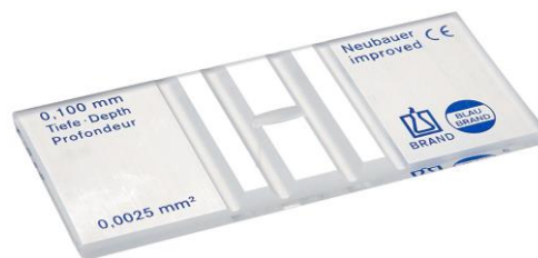
Figura 8. Cámara de Neubauer o hemocitómetro que permite el conteo de células basado en cuatro cuadrantes para determinar la densidad celular de una muestra.
