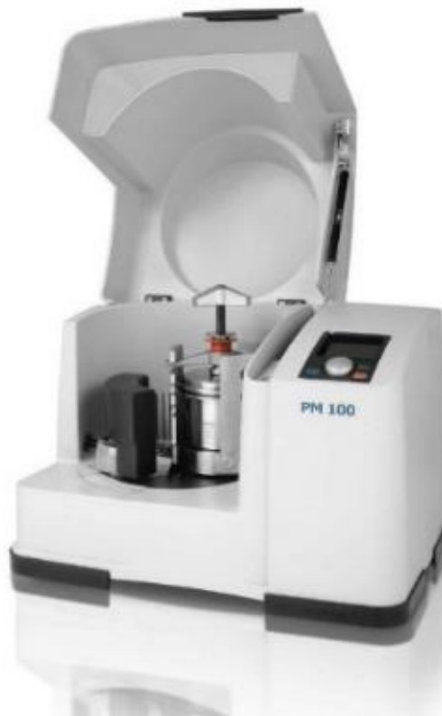
A1. Molino de bolas planetario PM100 utilizado para el proceso de alienación mecánica. Fuente: (6).
