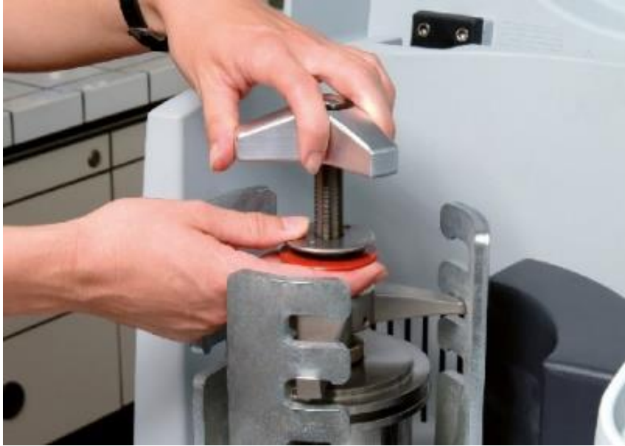
A3. Visión interior del molino de bolas planetario, con su sistema de ajuste. Fuente: (6).
