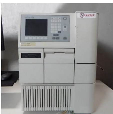
Figura 9. HPLC-DAD modelo Waters 2695 Separations Moduley.
