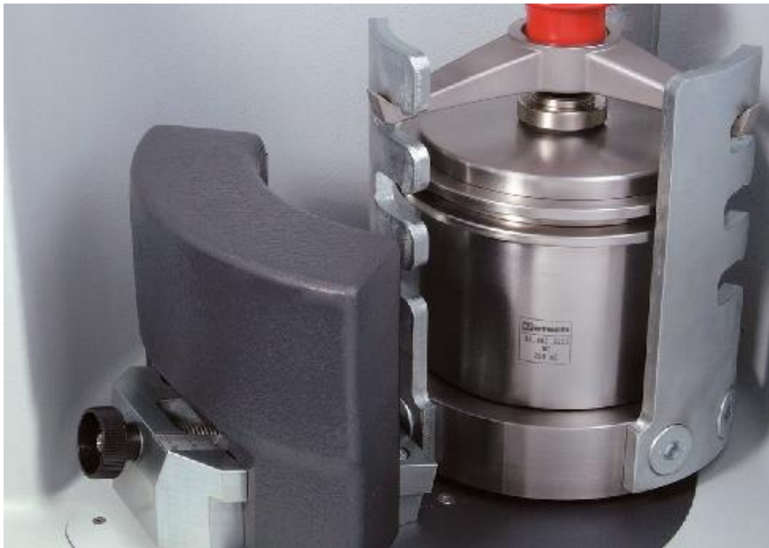
A4. Visión interior del molino de bolas planetario, con su sistema de ajuste. Fuente: (6)
