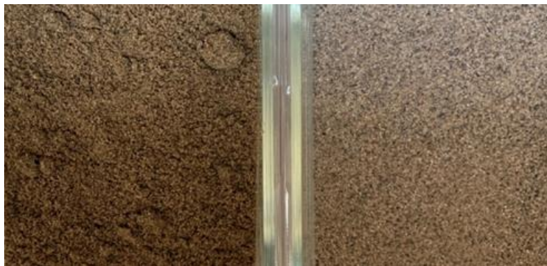
Ilustración 65 Arena fina húmeda y seca por microondas
