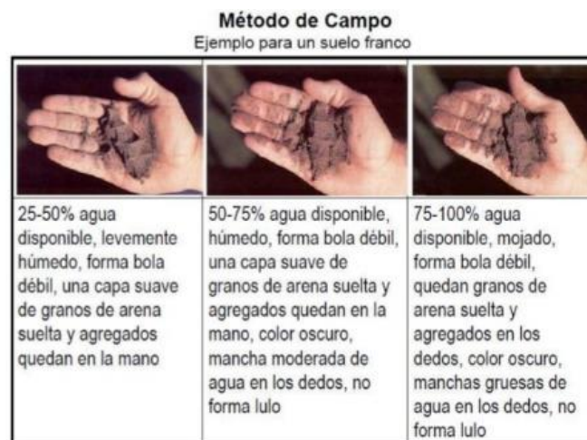
Ilustración 15 Prueba compresión de bola (Gil-Montenegro, 2018)
