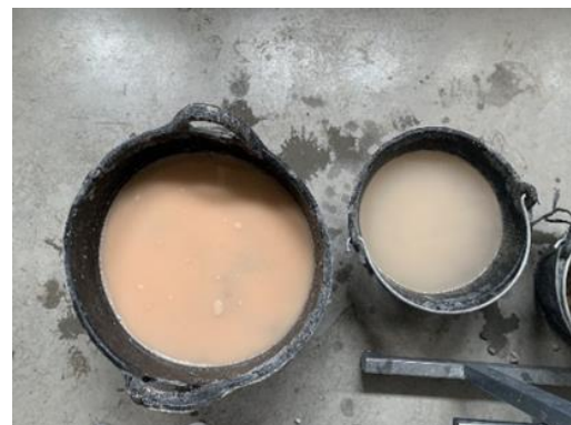
Ilustración 77 Gravass saturadas removidas
