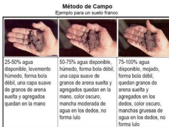
Ilustración 15 Prueba compresión de bola (Gil-Montenegro, 2018)
