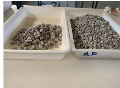
Ilustración 75 Contaminación AG y AF granulometría gravas
