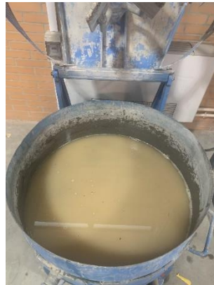
Ilustración 72 AG saturado en mezcladora
