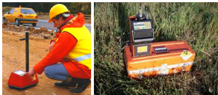
Ilustración 19 Equipo método nuclear Universidad Católica de Valparaíso (1993)
