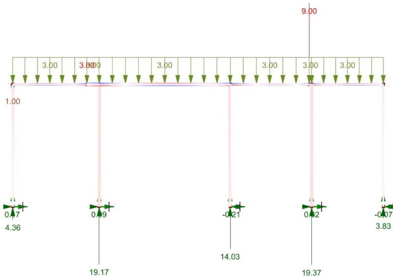
Figura 90 Reacciones del caso 3 obtenidas mediante Karamba 3D.
