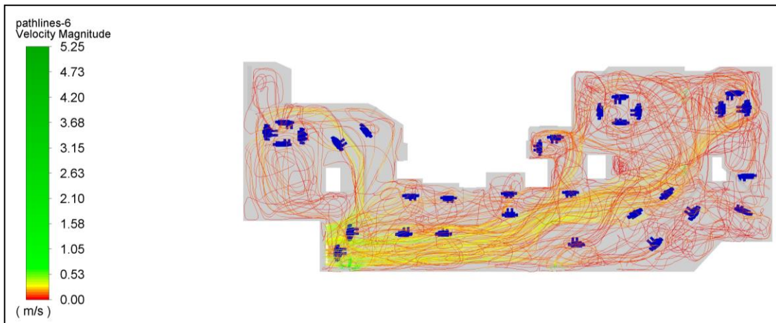
ANEXO 5 Imagen 20. Vista en planta de las líneas de flujo donde en rojo se encuentran las menores velocidades y en verde las mayores. Caso TEORICO. Fuente: elaboración propia
