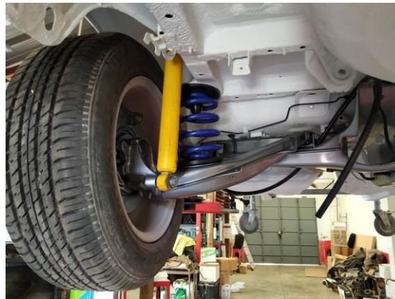
Ilustración 17: Detalle del conjunto de muelle y amortiguador instalado. Fuente, elaboración propia.
