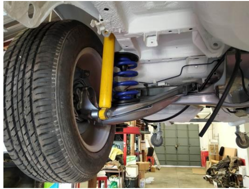
Ilustración 19: Detalle de los brazos de suspensión traseros instalados. Fuente, elaboración propia.
