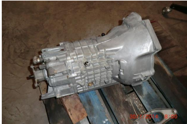
Ilustración 16: Caja de cambios procedente del vehículo donante. Fuente: Elaboración propia.
