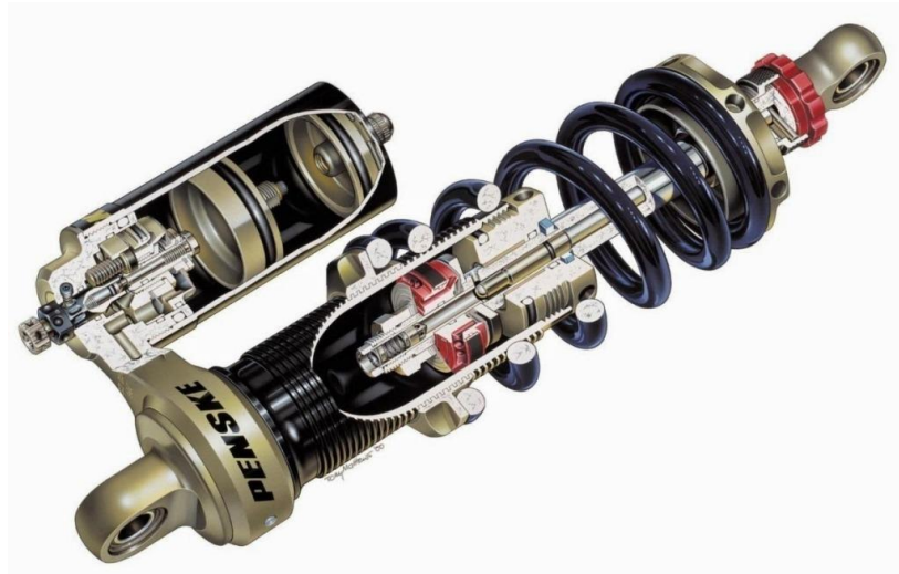
Ilustración 42: Vista seccionada de un amortiguador regulable con botella externa. Fuente: (FIL, 2017). 30
