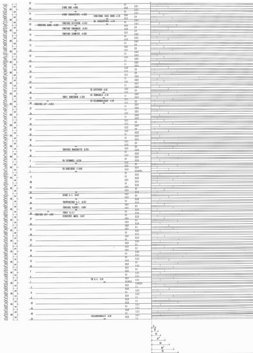
Figura 58: Peter Zumthor, detalle constructivo del despiece de la piedra en fachada Theme Vals, Grisones (1990-1996)
