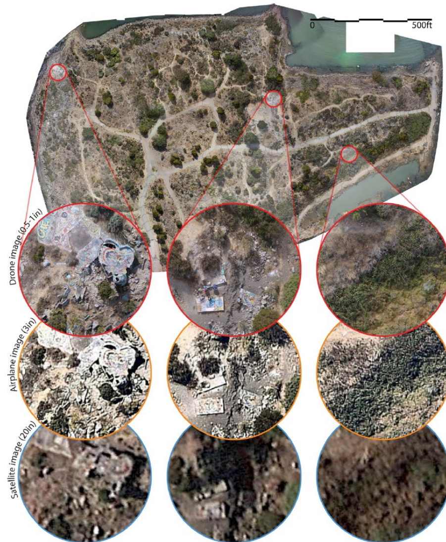
Fig 1.24. La vista a ojo de drone: ortomosaico del vertedero Albany Bulb comparación imagen satélite e imágenes aéreas (captura de la imagen drone con 3DRobotics Solo equipado con cámara Sony UMC-R10C a 60m, 2017)
