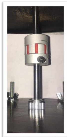
Figura 60 – Acople oldham y acople eje-disco colocados en la plataforma interna
