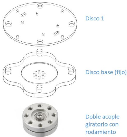
Figura 24 – Parte inferior de la estructura interna
