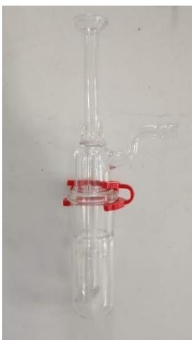
*Figura 7. Condensador*
