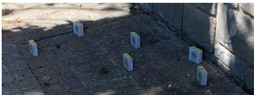
Figura 7.1- Re calibración de los sensores CO 2 . Fuente: Elaboración propia
