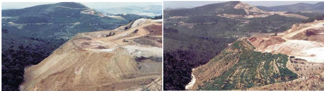
Figura 46. Ejemplo de una escombrera restaurada en La Rioja. Fuente. Gobierno de la Rioja
