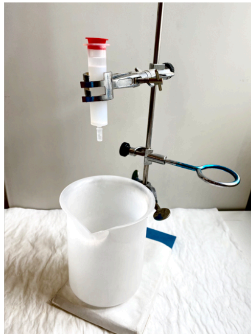
FIGURA 3 | Fotografía de la disposición del sistema de Cromatografía de Exclusión de Tamaño. Se coloca la columna en un soporte y debajo de ella una cubeta para desechos.
