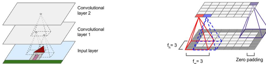
**Figura 4.3.** Funcionamiento capa convolucional bidimensional [28]
