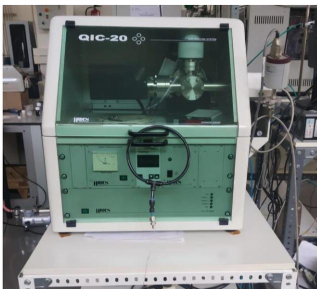
Figura 11. Espectrómetro de masas QIC-20
