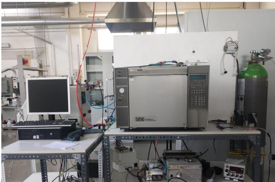
**Figura 9. Sistema experimental de adsorción de CO<sub>2</sub> en lecho fijo.**
