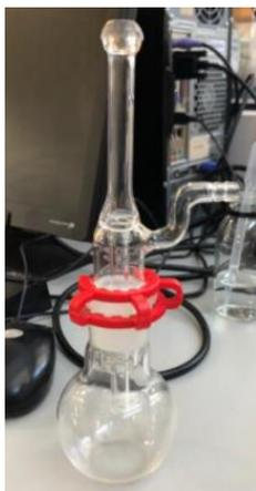
**Figura 4. Condensador de vapores.**
