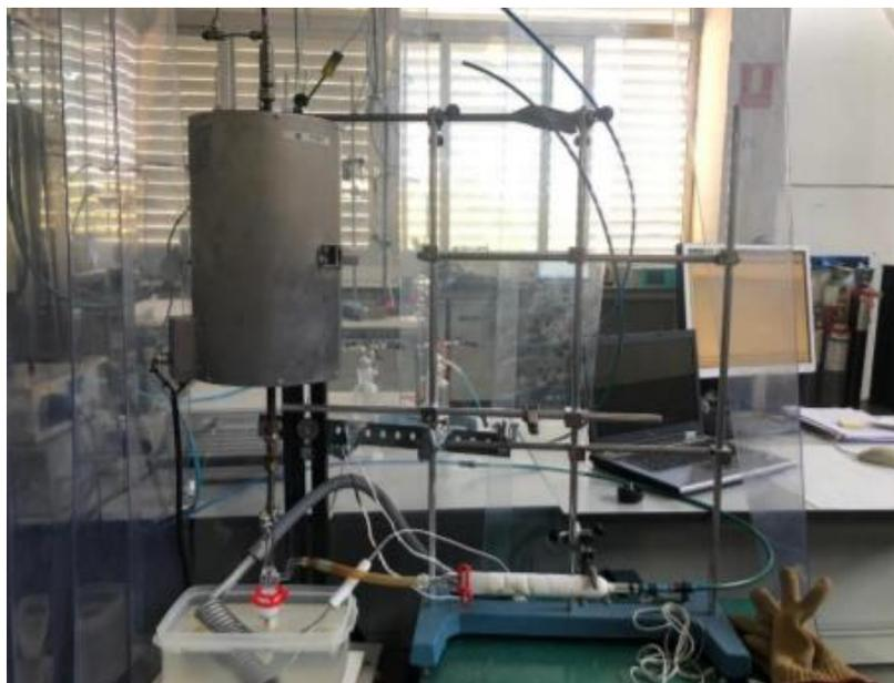
**Figura 1. Sistema experimental real de pirólisis en lecho fijo.**
