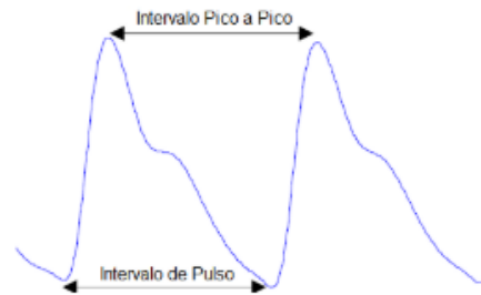
Figura 5. Señal PPG y puntos de interés.
