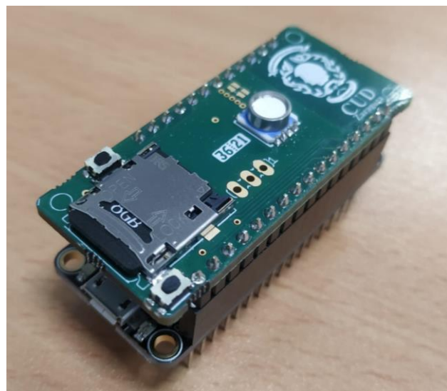
Figura 14. PCB sistema de resgistro conectado.
