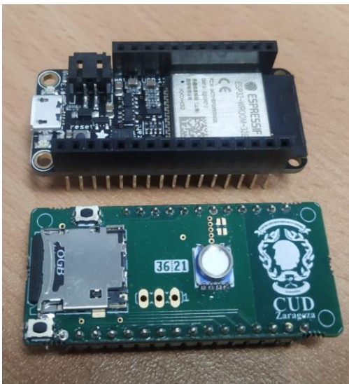
Figura 13. PCB fabricada y ESP32.
