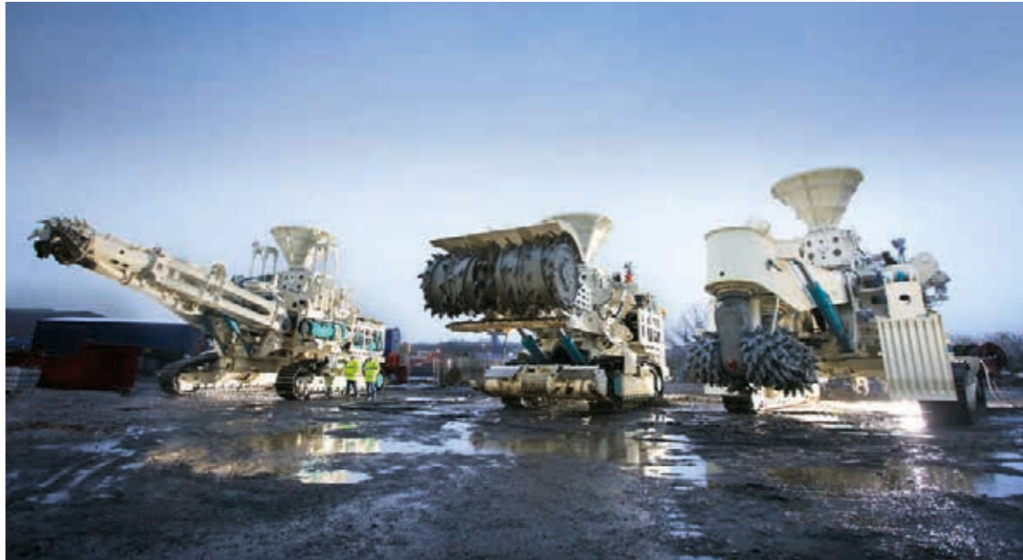
5.12 > Für den Abbau einer Massivsulfid-lagerstätte in der Bismarcksee vor Papua-Neuguinea hatte die inzwischen insolvent gegangene kanadische Firma Nautilus Minerals drei ferngesteuerte Unterwasserfahrzeuge entwickelt: eine Fräse (rechts), einen Schüttgutschneider (Mitte) und einen Kollektor (links).
