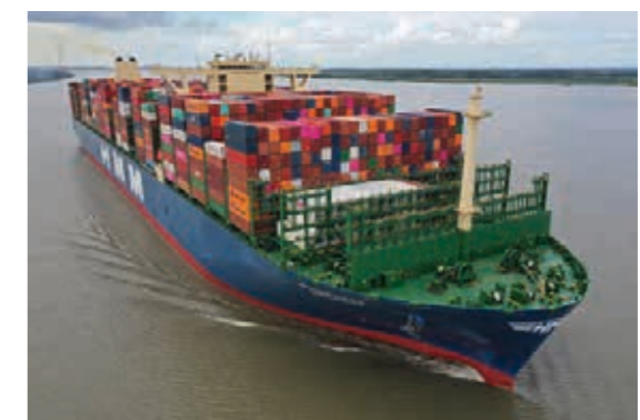
4.2 > Der Megafrachter „HMM Hamburg“ ist 400 Meter lang und kann 23 964 Container laden. Damit gehört das Schiff, welches im Linienverkehr zwischen Europa und Ostasien fährt, zu den größten Containerschiffen der Welt.
