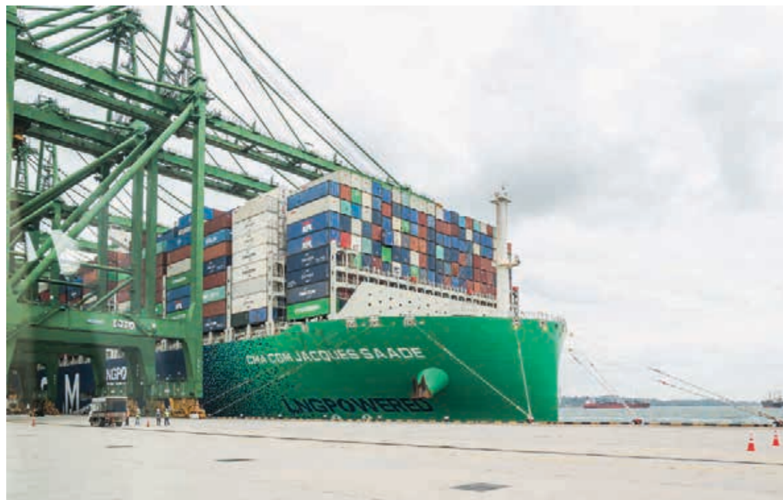
4.15 > Keine schwarzen Rußwolken mehr: Das Containerschiff „Jacques Saadé“ der französischen Reederei CMA CGM wird mit Flüssiggas betrieben und ist der bislang größte Frachter mit einem solchen alternativen Antrieb.
