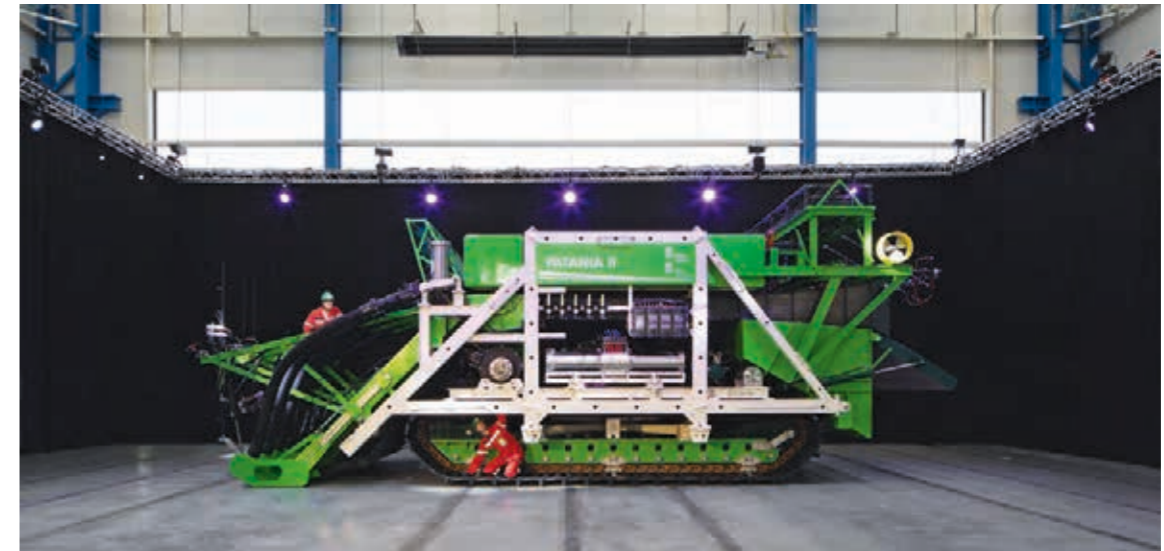
5.11 > Zwölf Meter lang, 4,5 Meter hoch, vier Meter breit und 25 Tonnen schwer ist Patania II, ein raupenähnlicher Manganknollen-Kollektor der belgischen Firma DEME-GSR. Der Prototyp wurde im Frühjahr 2021 erstmals in der Clarion-Clipperton-Zone in 4500 Meter Wassertiefe getestet.
