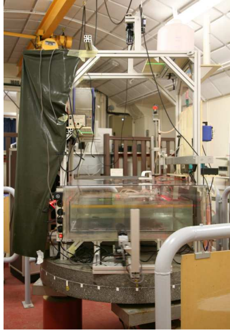
FIG. 3.6: La table tournante de l'ENSTA. On peut distinguer quelques éléments importants : les deux plaques de granit, des caméras utilisées pour des prises de vue au-dessus et sur le côté de la cuve, la cuve en verre et le couvercle en Plexiglas.
