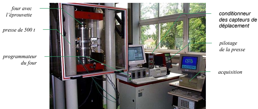
Figure 47 : Ensemble du système d'essais
