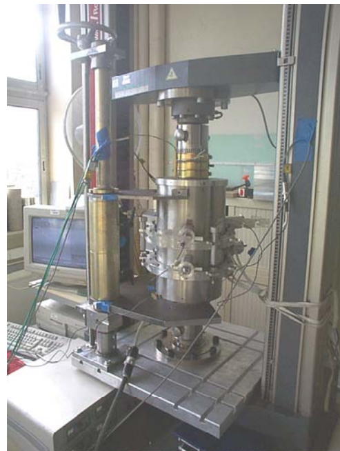
Figure 50 : Dispositif permettant la réalisation d'étude de la traction directe « à chaud » sur matériau béton
