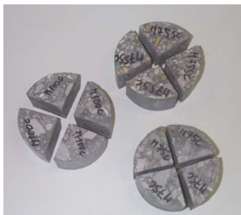
Figure 78 : Echantillons utilisés dans l'étude : un quart de Ø 104mm et hauteur de 60mm
