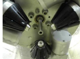
(b) Fonction de polissage : galets coniques de polissage
