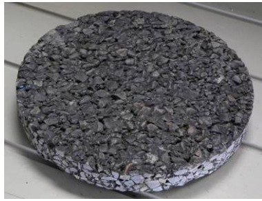
(a) Carotte de mélanges bitumineux
