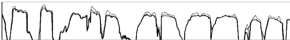
Figure V.5 : Évolution de la texture, cas du granulat B (PSV = 55)
