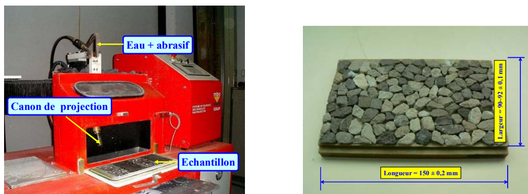
Figure II.19 : Essai de polissage par projection et un exemple d'échantillon
