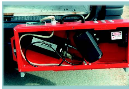
Figure II.13 : Méthode profilométrique : le RUGOLASER
