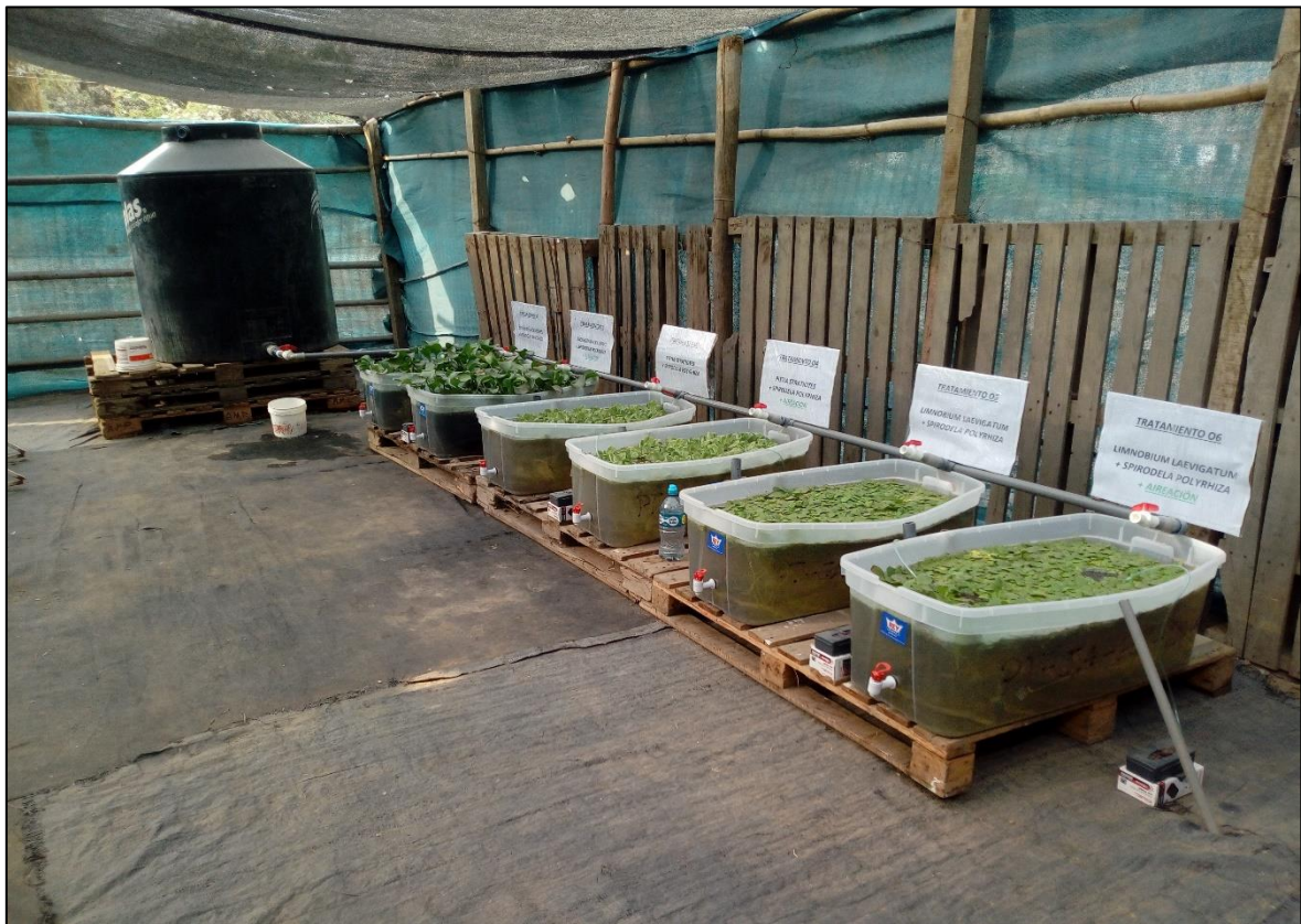
Figura 49. Estado del sistema piloto de fitodepuración a los diez (10) días.
