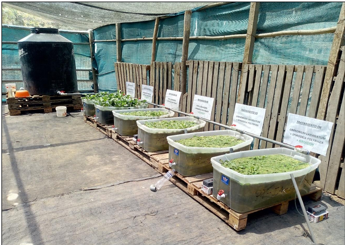
Figura 45. Estado del sistema piloto de fitodepuración a los cinco (5) días.
