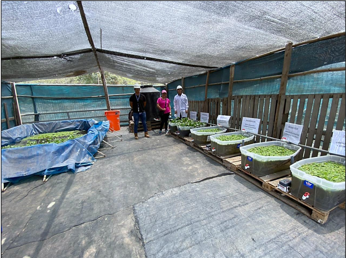
Figura 50. Estado del sistema piloto de fitodepuración al término de la corrida experimental
