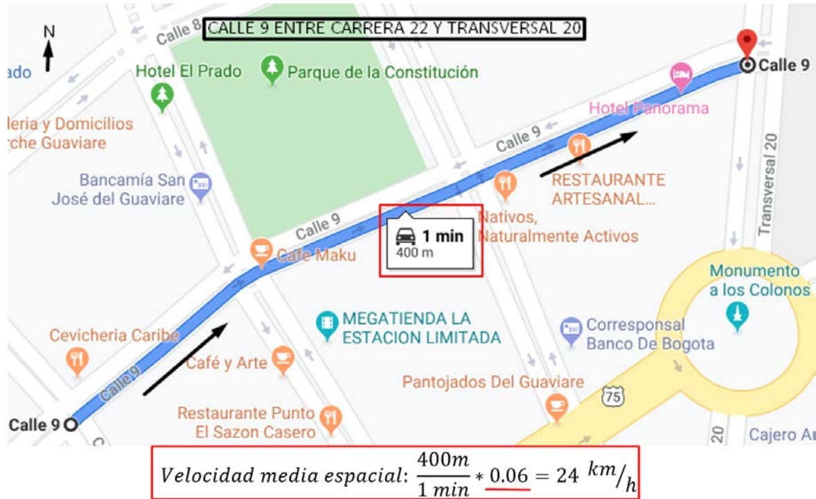
Figura 3-13: Cálculo de velocidad media espacial \bar{v}_e en \frac{\text{Kilometro}}{\text{hora}} .
