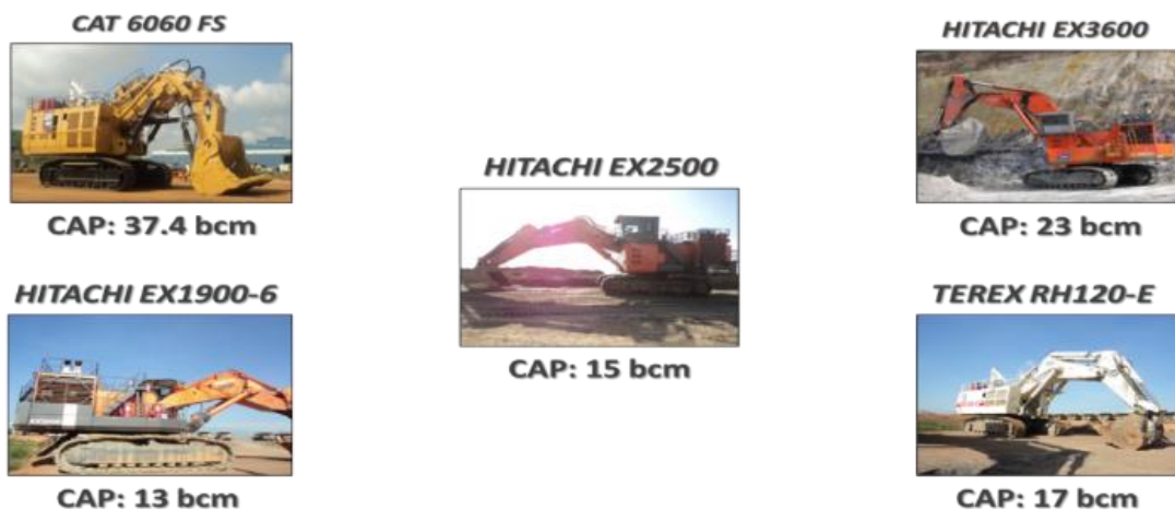
Figura 3-8 Equipos de cargue de estéril
