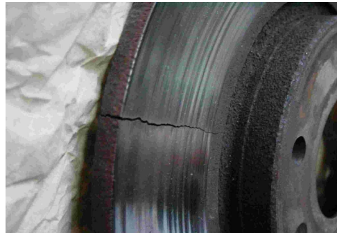
FIG. 1.10: Fissure radiale sur les pistes de frottement
