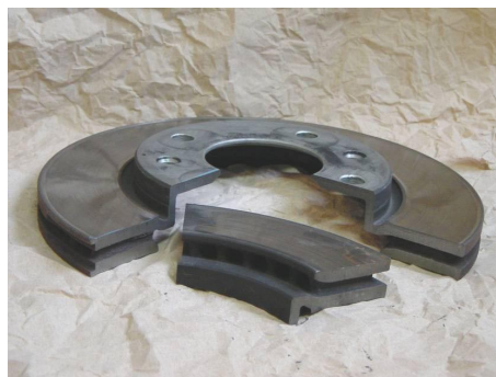
FIG. 1.6: Exemple de disque ventilé
