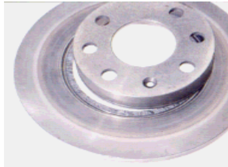
FIG. 1.12: Rupture dans la gorge du bol
