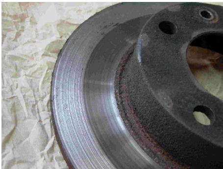
FIG. 1.15: Usure des pistes
