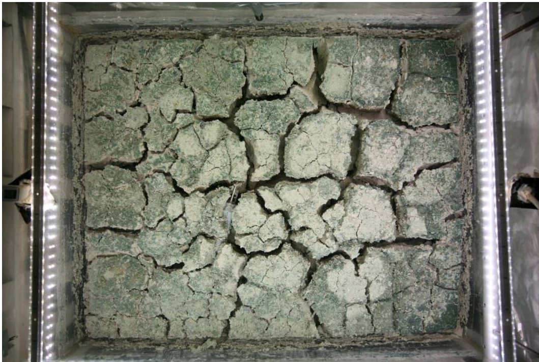
Figure III.20. Séchage 4 - réseau de fissures à la surface du sol après 70 jours d'essai
