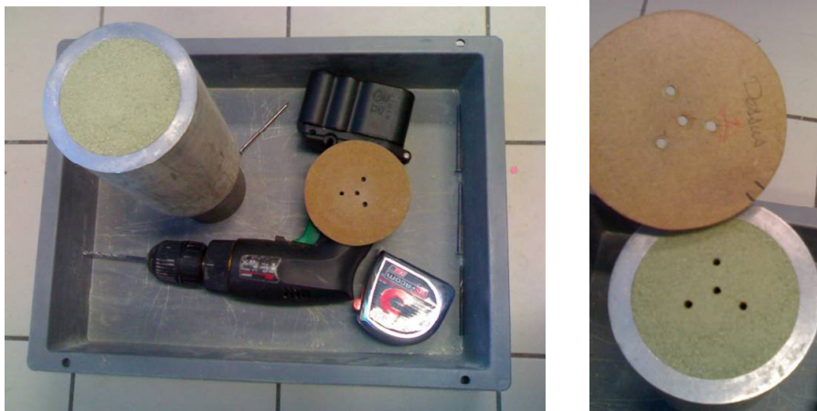
Figure II.3. Préparation des mesures du capteur TP. Réalisation des pré-trous
