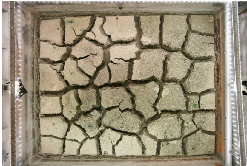
Figure III.15. Séchage 3 - réseau de fissures à la surface du sol après 30 jours d'essai
