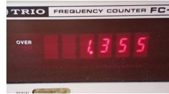
**Gambar 19** Tampilan Alat Ukur Frekuensi pada output CLK2
