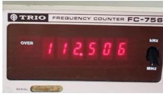
**Gambar 15** Tampilan Alat Ukur Frekuensi pada output CLK0
