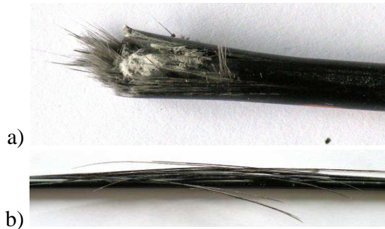
Fig. 8: a) Rupture d'un élastica avec torsion; b) Rupture d'un élastica sans torsion
