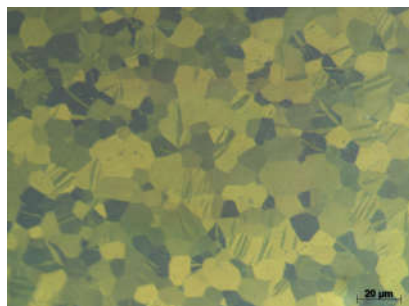
Optimales Präparationsergebnis durch Zugabe von H 2 O 2 in das Oxidpoliermittel (polarisiert)
