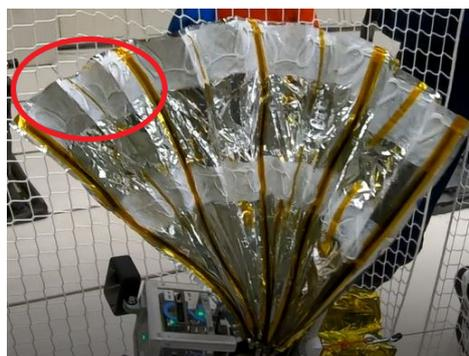
Abbildung 7.11.: Ebenheit des Space-Wings (rote Markierung: sichtbare Faltkanten)
