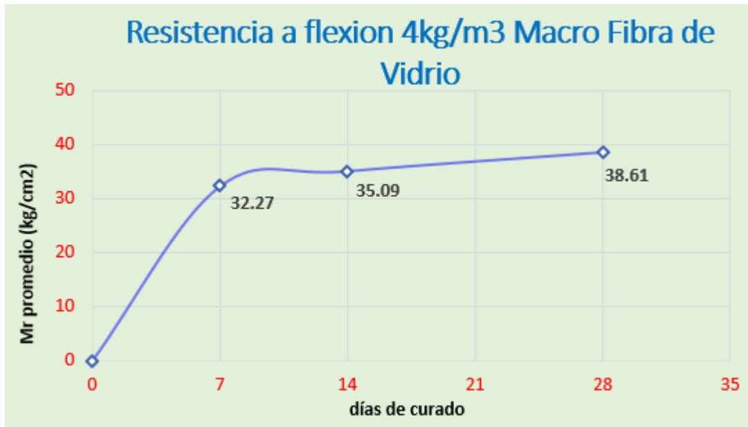
Figura 22: Curva resistencia vs Tiempo - Flexión 4kg/m3 Macro fibra de vidrio
