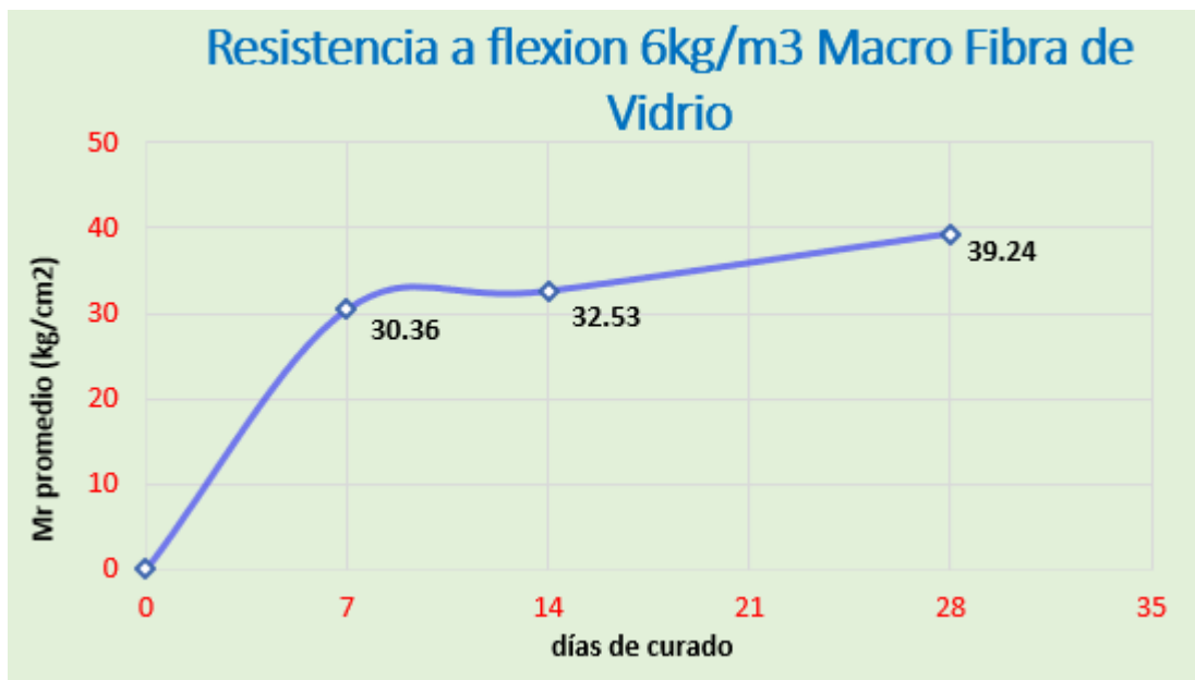
Figura 24: Curva resistencia vs Tiempo - Flexión 6kg/m3 Macro fibra de vidrio
