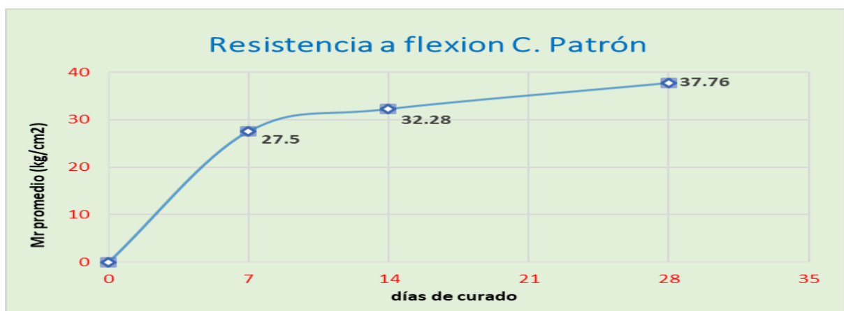
Figura 21: Curva resistencia vs Tiempo - Flexión _ Patrón
