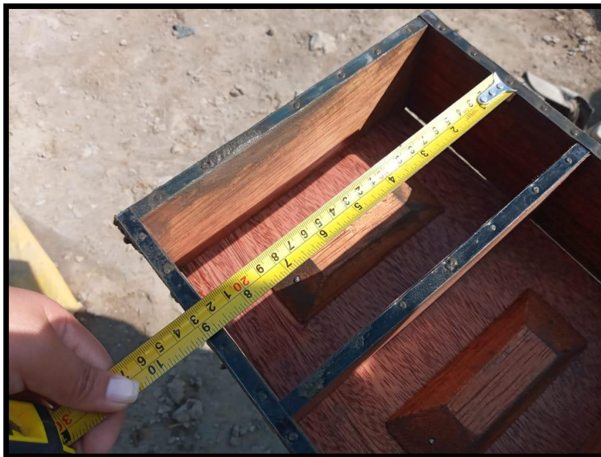
Figura 18. Medida del molde del ladrillo
