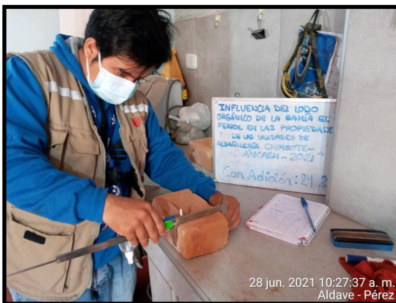
Figura 66. Se observa el ensayo de la variación dimensional.
