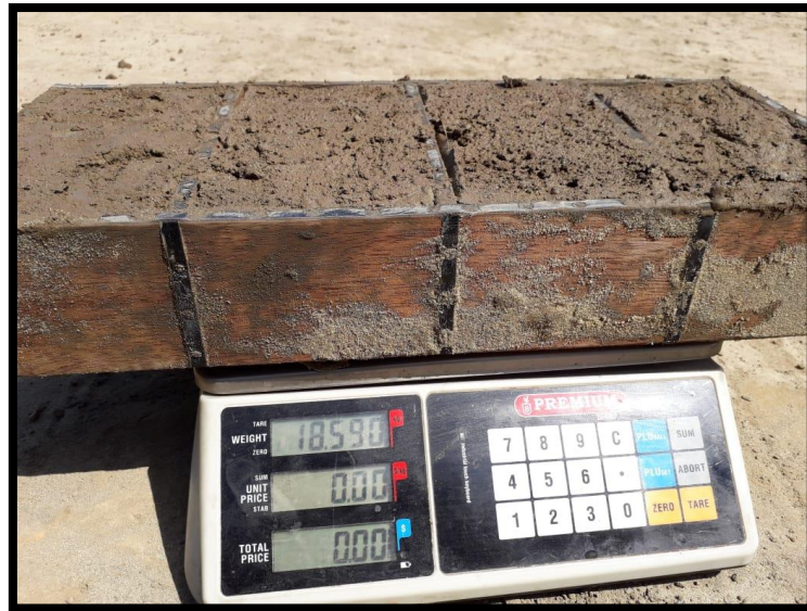
Figura 27. Se peso el molde con el lodo
