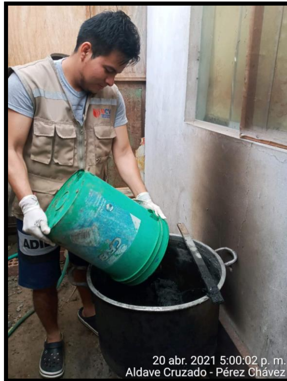
Figura 11. Se agrego 1 balde de lodo y dos de agua, proporción 1:2
