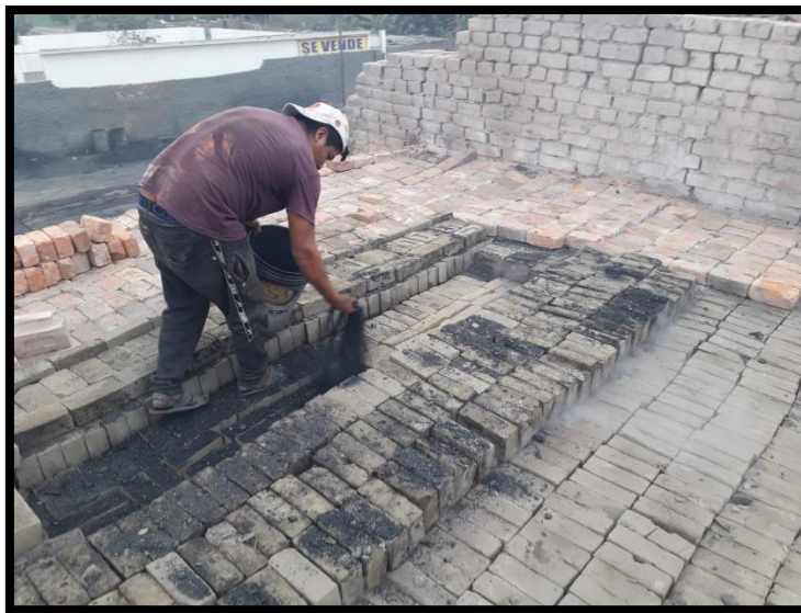
Figura 39. Se le agrega carbón en polvo encima de las muestras de ladrillo.
