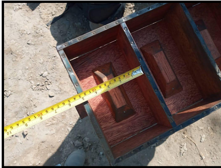
Figura 17. Medida del molde del ladrillo
