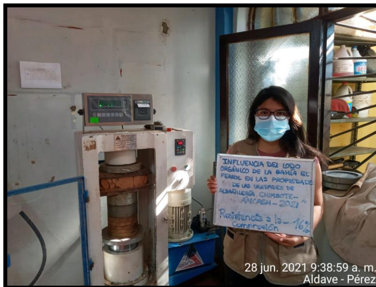
Figura 70. Se observa el ensayo de resistencia a la compresión
