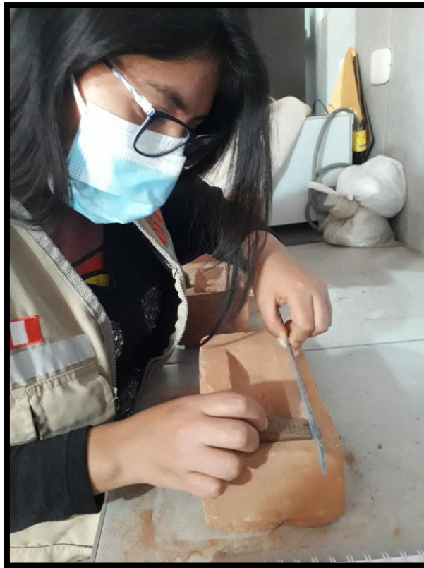
Figura 67. Se observa el ensayo de alabeo
