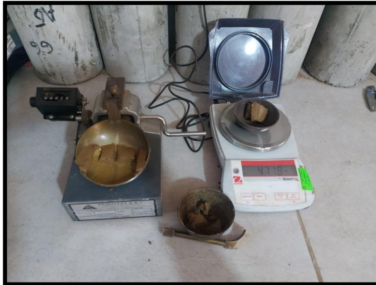
Figura 51. Instrumentos para la elaboración de los ensayos, limite plástico y limite líquido.
