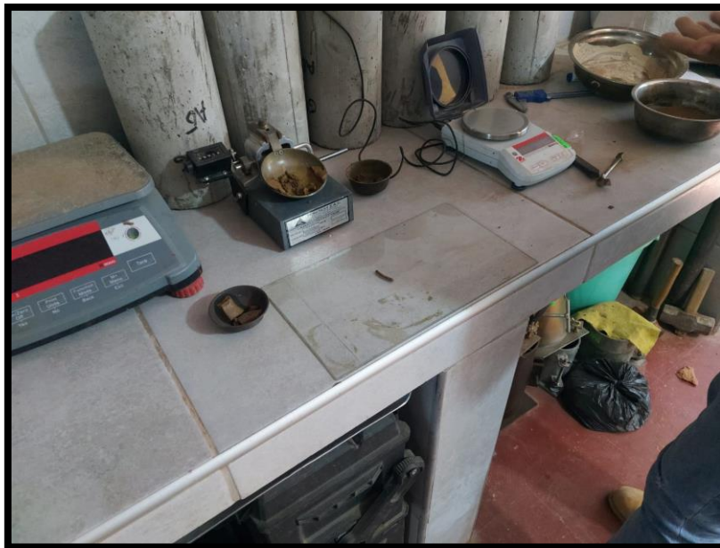
Figura 56. Se realiza el ensayo de limite plástico
