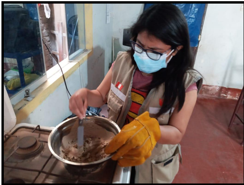
Figura 50. Se seca la muestra en la cocina.
