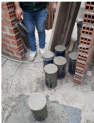
Los moldes con su respectiva mezcla incluyendo al PLA (ÁCIDO POLILÁCTICO).
