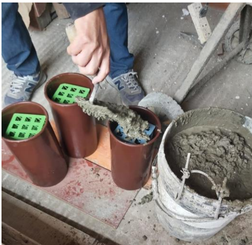
Invirtiendo la mezcla en los Moldes.
