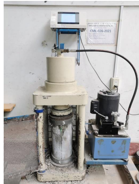
Imagen desde el momento de la ubicación del testigo en la maquina de ensayo a la compresión
