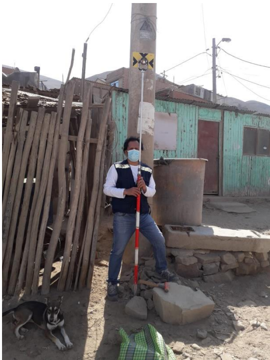
Imágenes de trabajo de campo para la captura de puntos por la estación total
