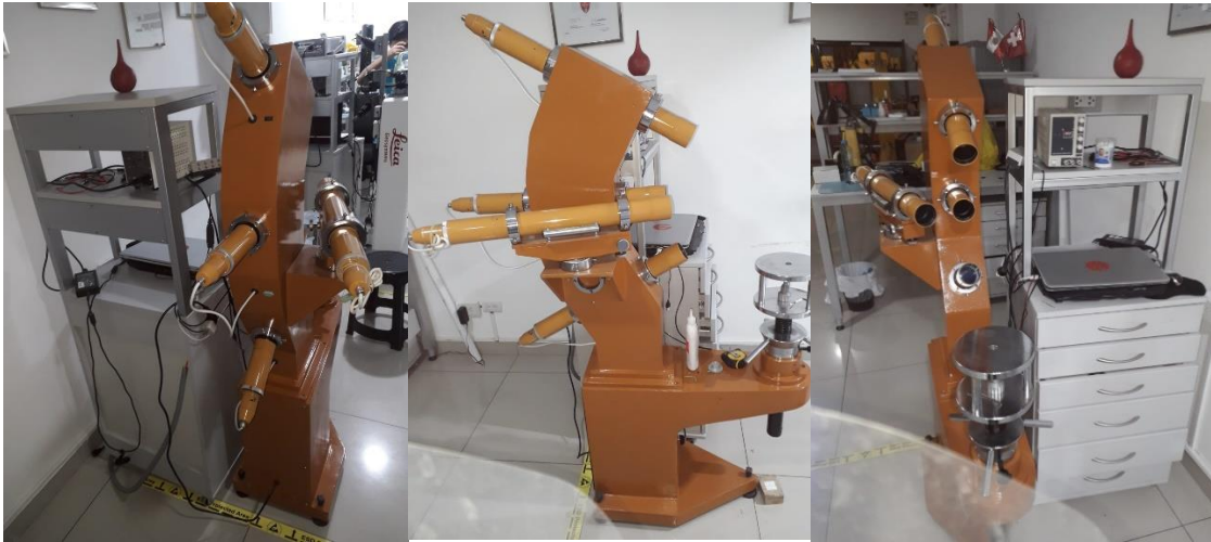
imágenes de vistas del equipo equilibrador de estaciones totales
