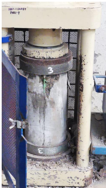
Imagen desde el momento de la ruptura del concreto celular y resultado del ensayo a los 13 días.
