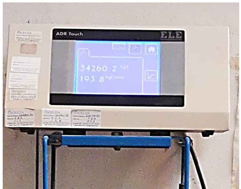
Imagen desde el momento de la ruptura del concreto celular y resultado del ensayo a los 13 días.
