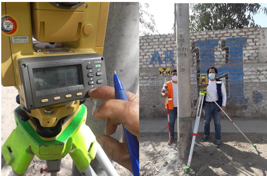
Imágenes del ingreso de datos para marcar el punto de posicionamiento para poder geo referenciar en la zona.
