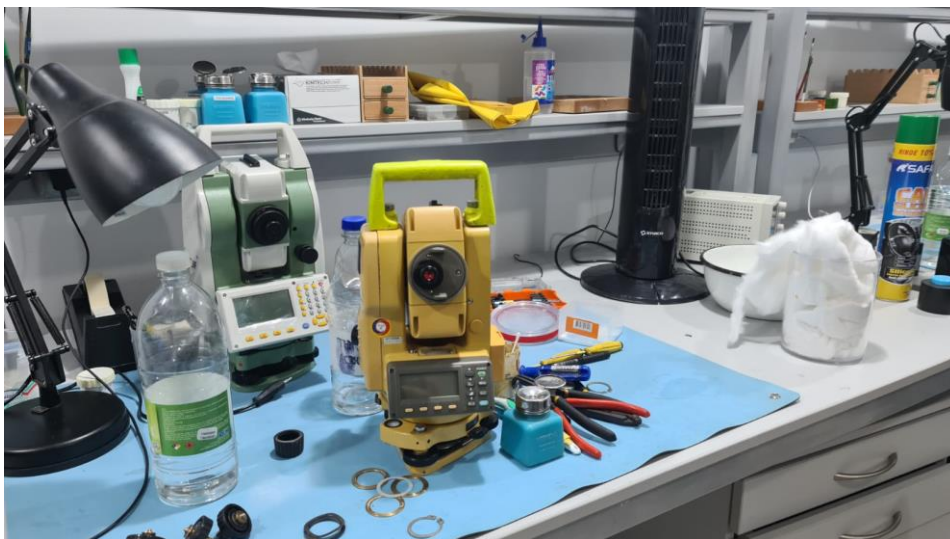
Imagen del momento en donde se va a realizar el mantenimiento a la estación Total
