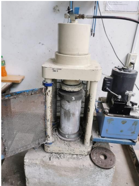
Imagen desde el momento de la ubicación del testigo en la maquina de ensayo a la compresión
