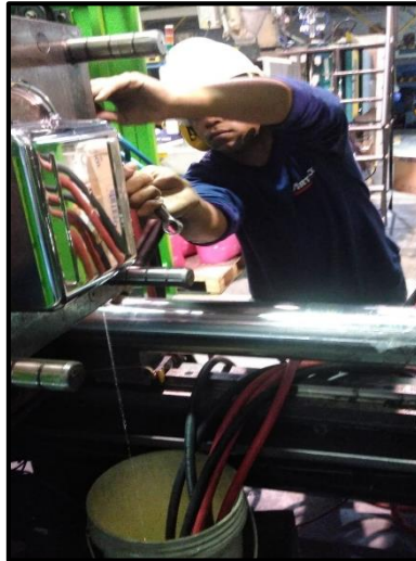
Figura 11. Cambio de molde de manera empírica
