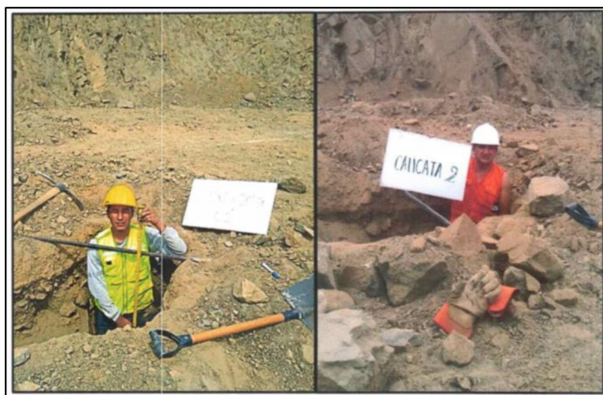
Figura 38. Excavacion d elas respctivas calicatas en la zona de estudio.
