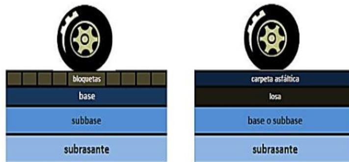
Figura 04: Sección típica transversal pavimento híbrido
