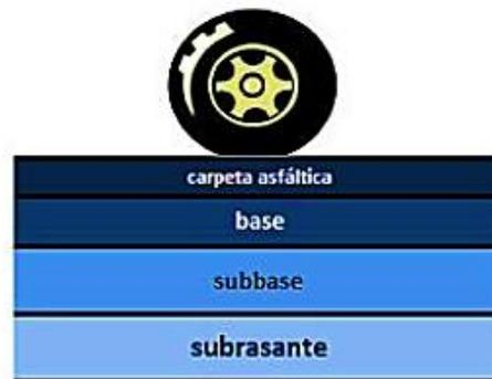
Figura 02: Esquema normal del haz subyacente de un asfalto
