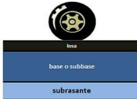
Figura 03: Sección típica transversal pavimento rígido
