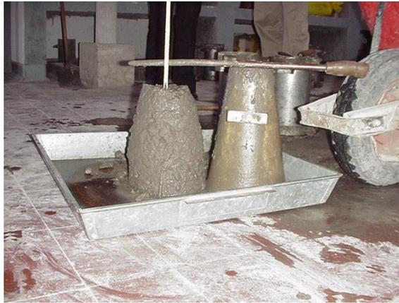
*Figura 06:* Ensayo de asentamiento con el cono o slump.
