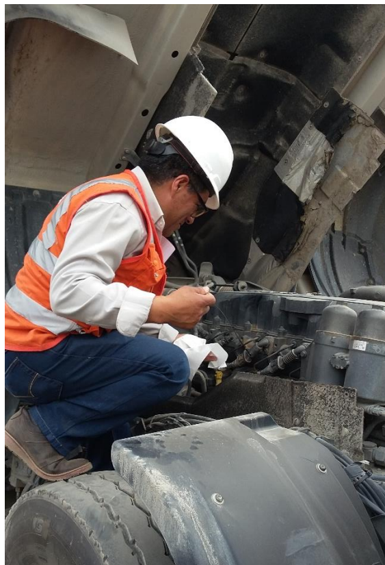
Conductor haciendo la revisión de niveles y lubricación a la unidad F7J-728
