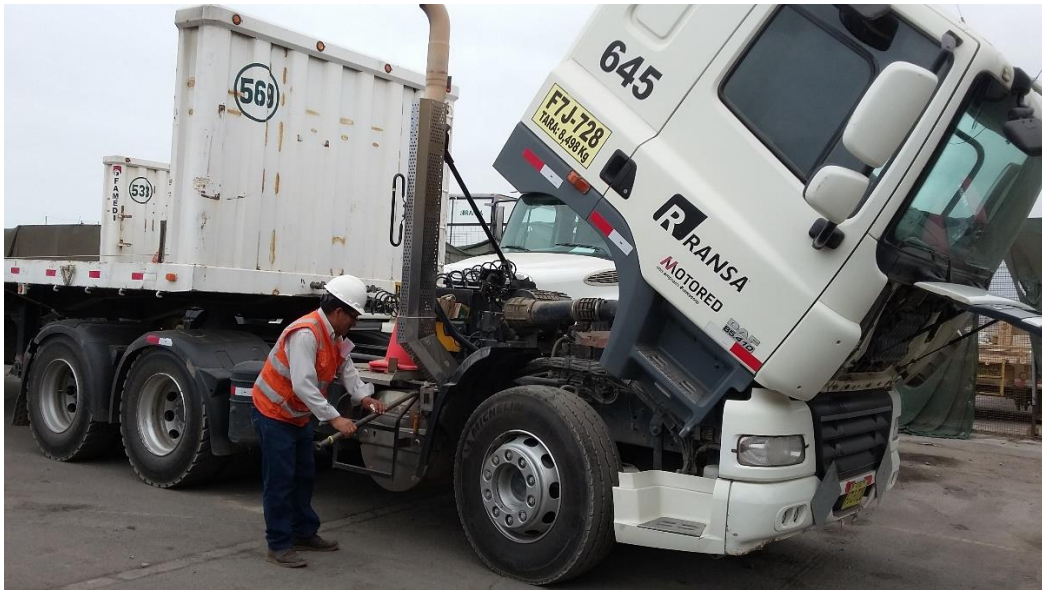
Conductor bajando la cabina de la unidad F7J-728 para el inicio del mantenimiento.
