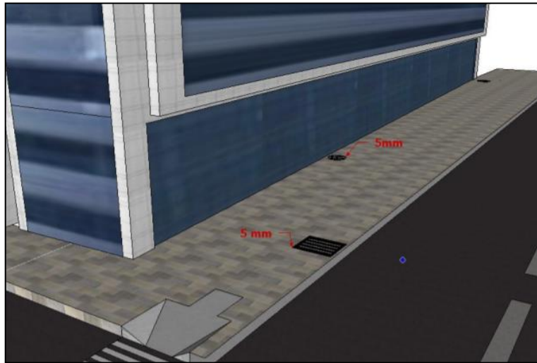
Figura 41. Aspectos constructivos de las aceras
