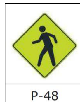
Figura 56. Señalización peatonal P- 48 Fuente: Manual de dispositivos de control de tránsito automotor para calles y carreteras, 2016
