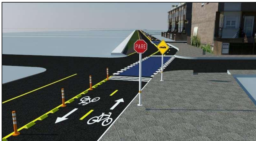
Figura 132. Señalizaciones complementarias para el proyecto
