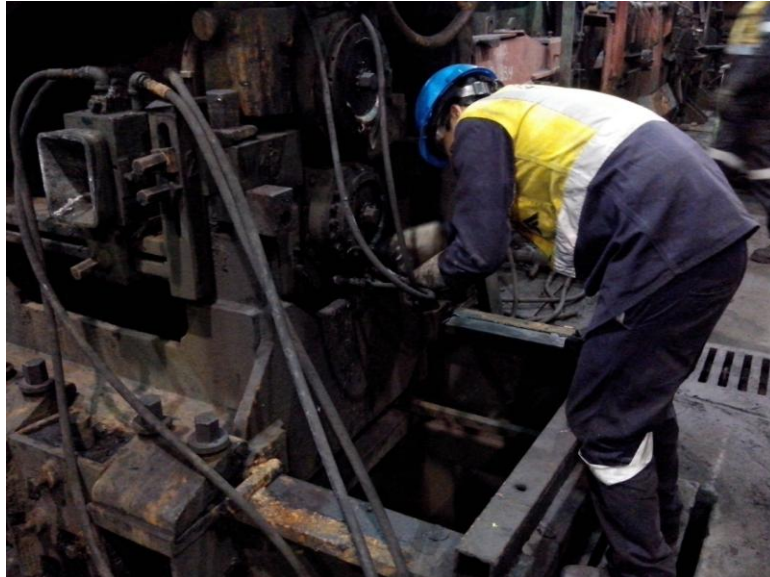
Figura 41 Situación actual- personal conectando puntos de lubricación
