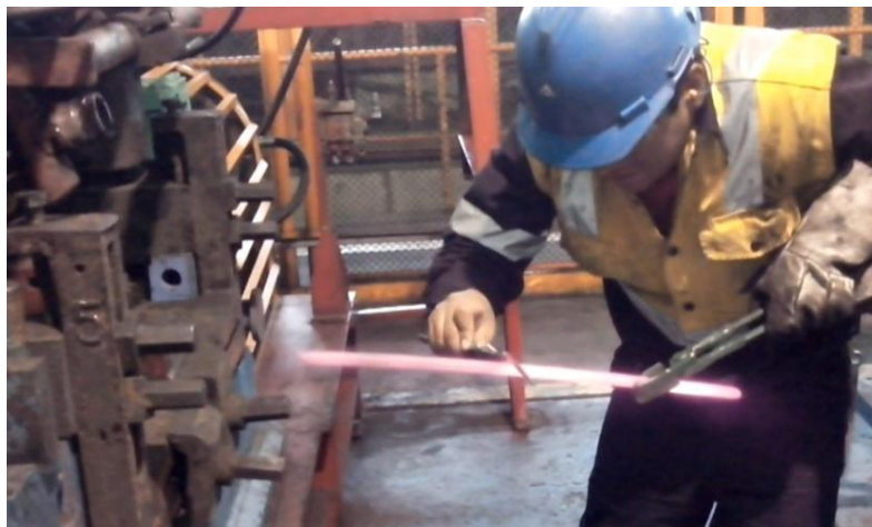
Figura 58 Personal de taller calibrando el espesor de la muestra
