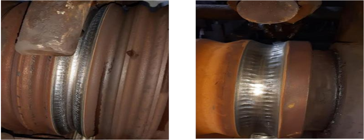
Figura 40 Canales agrietados por un incorrecto montaje de la ducha de refrigeración
