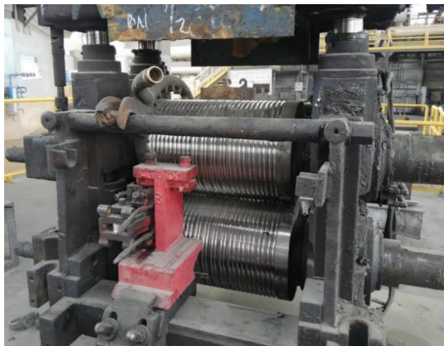
Figura 52 Ahora – Caseta de laminación con guías montadas
