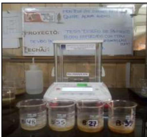
Figura 55: Ensayo de sales solubles y sulfato solubles.
