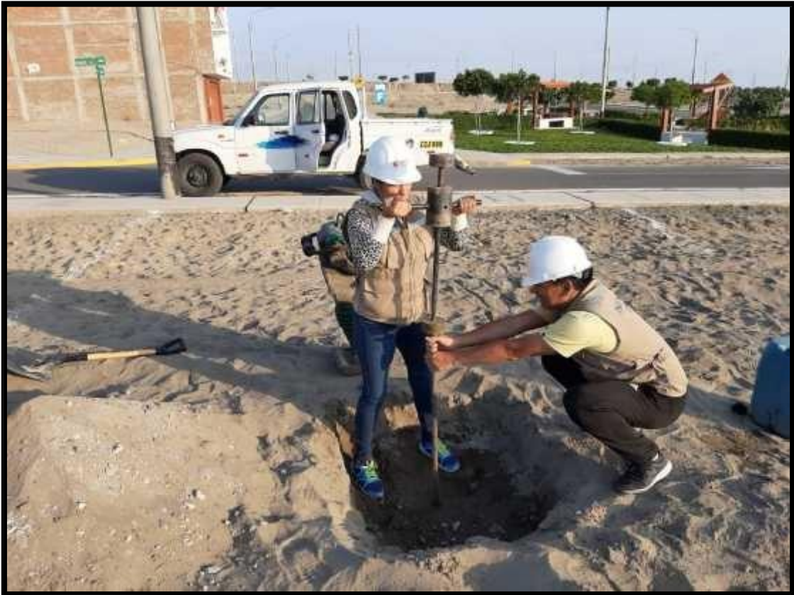
Ensayo de DPL con material estabilizado RCD AL 75% Y TERRENO NATURAL
