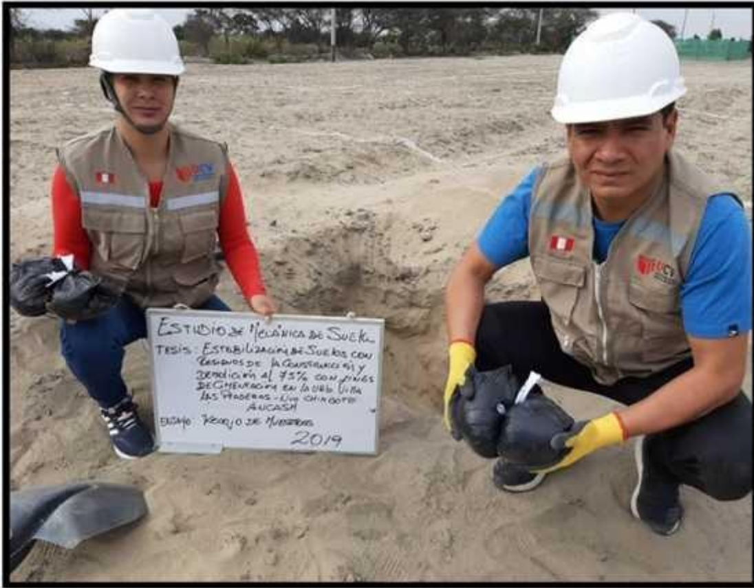
Excavación de calicata en la manzana B – lote 37 urbanización Villa Las Praderas y recojo de muestras de sus estratos, según la NTP E.050
