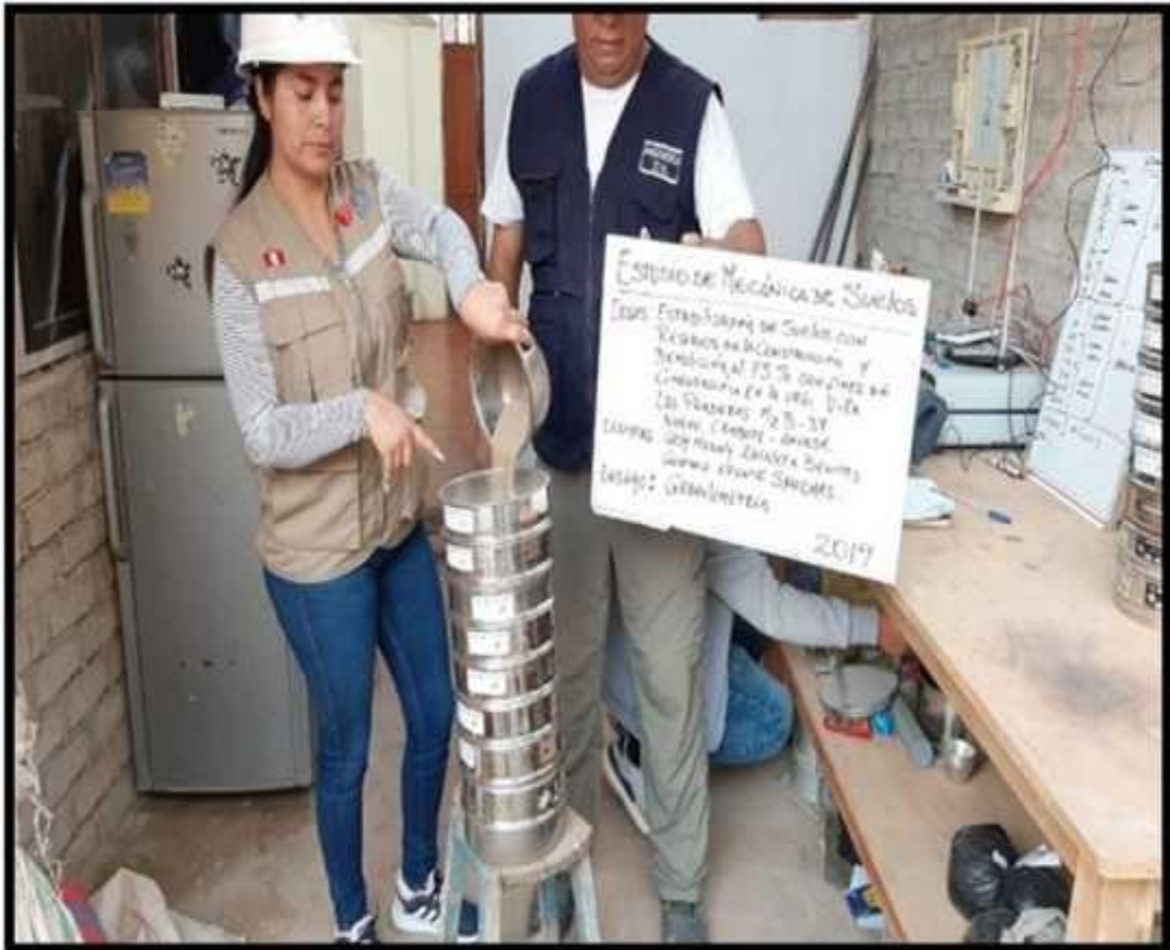
Ensayo de granulometría por juego de tamices estándar
