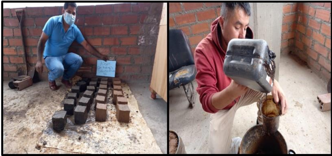
Gráfico 17 Jalado de adobes con adición de asfalto Rc-250 al 4%
