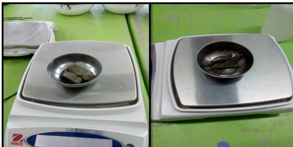
Gráfico 7 La masa de suelo se le convierte en rollitos de 3mm
