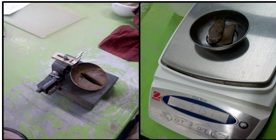
Gráfico 6 La masa de suelo se le acomoda en la maquina Casagrande
