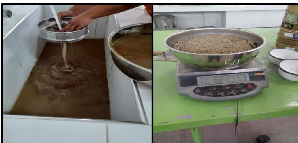
Gráfico 10 Pesado y lavado de tierras para la granulometría
