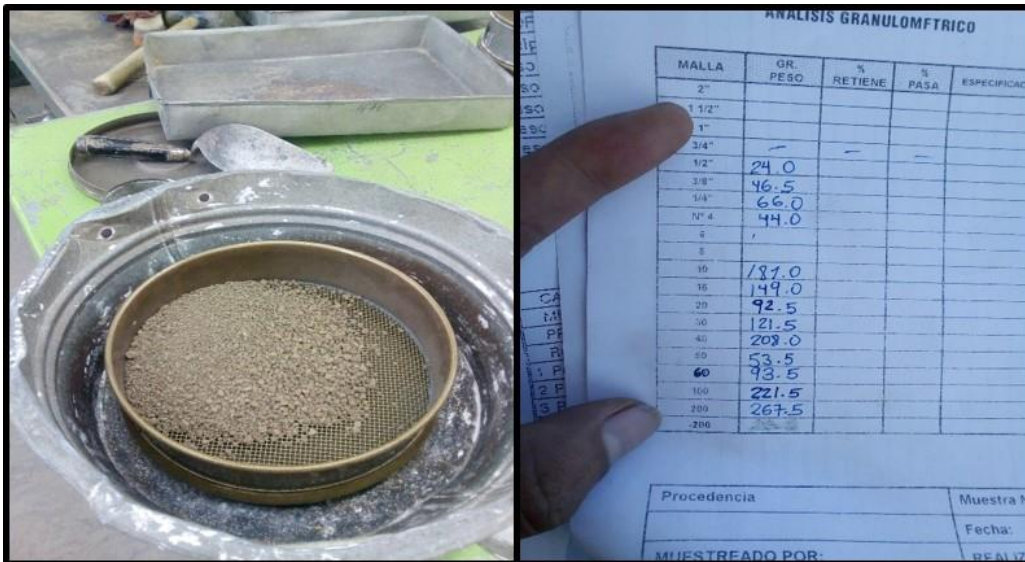
Gráfico 12 Se procede a anotar los pesos retenidos en cada malla
