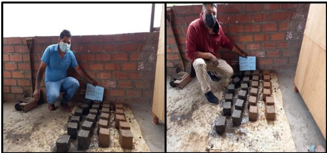
Gráfico 18 Jalado de adobes con adición de asfalto Rc-250 al 7%
