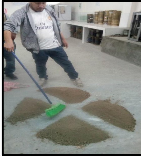
Gráfico 1 Se muestra el cuarteo de la tierra en el laboratorio de suelos
