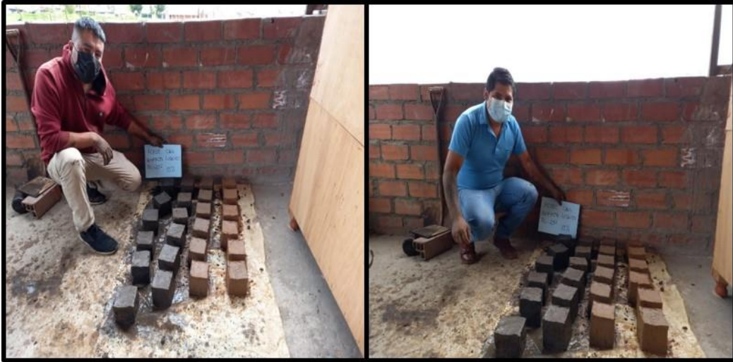
Gráfico 19 Jalado de adobes con adición de asfalto Rc-250 al 10%
