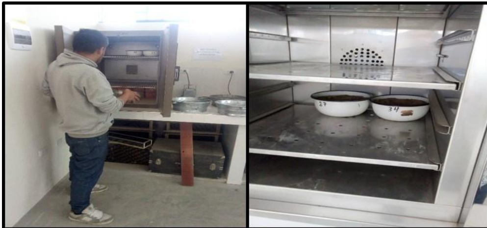
Gráfico 4 Secado de la tierra en horno 24 horas
