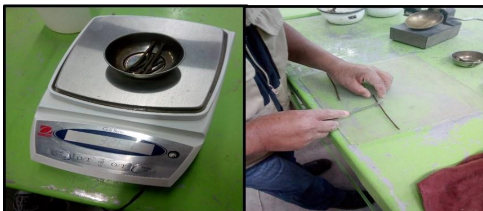
Gráfico 8 Se cortan los rollitos para hacerlos secar en horno
