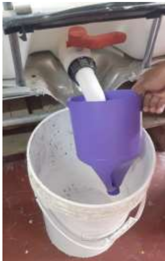
Figura 90. Trabajador usa embudo para evitar mojar el suelo
