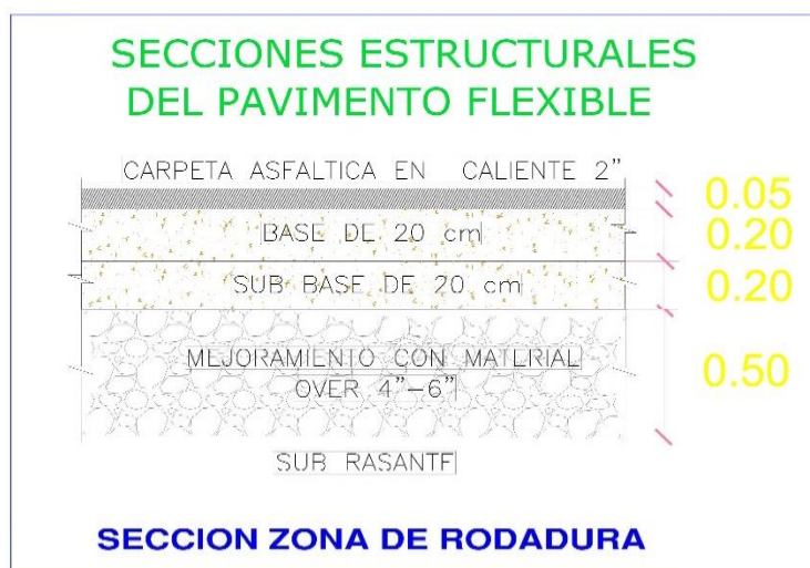
Figura N°2: Estructura tipo II del pavimento flexible
