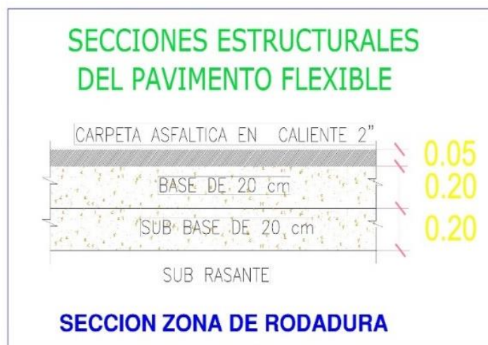
Figura N°1: Estructura tipo I del pavimento flexible
