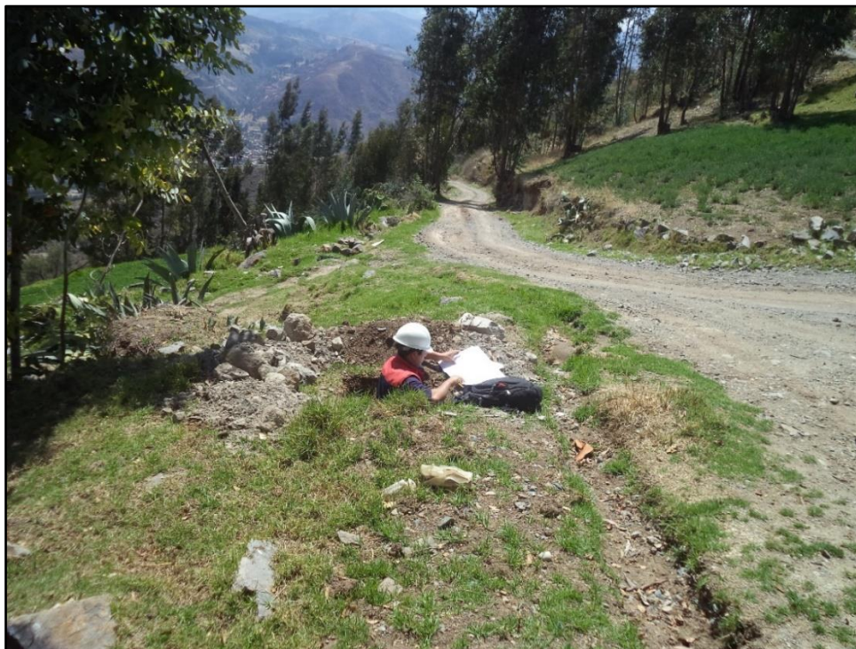
Fotografía 17. Se observa la Calicata N°8 con el tesista realizando las anotaciones correspondientes a nivel de estratigrafía y los estudios de suelos necesarios.
