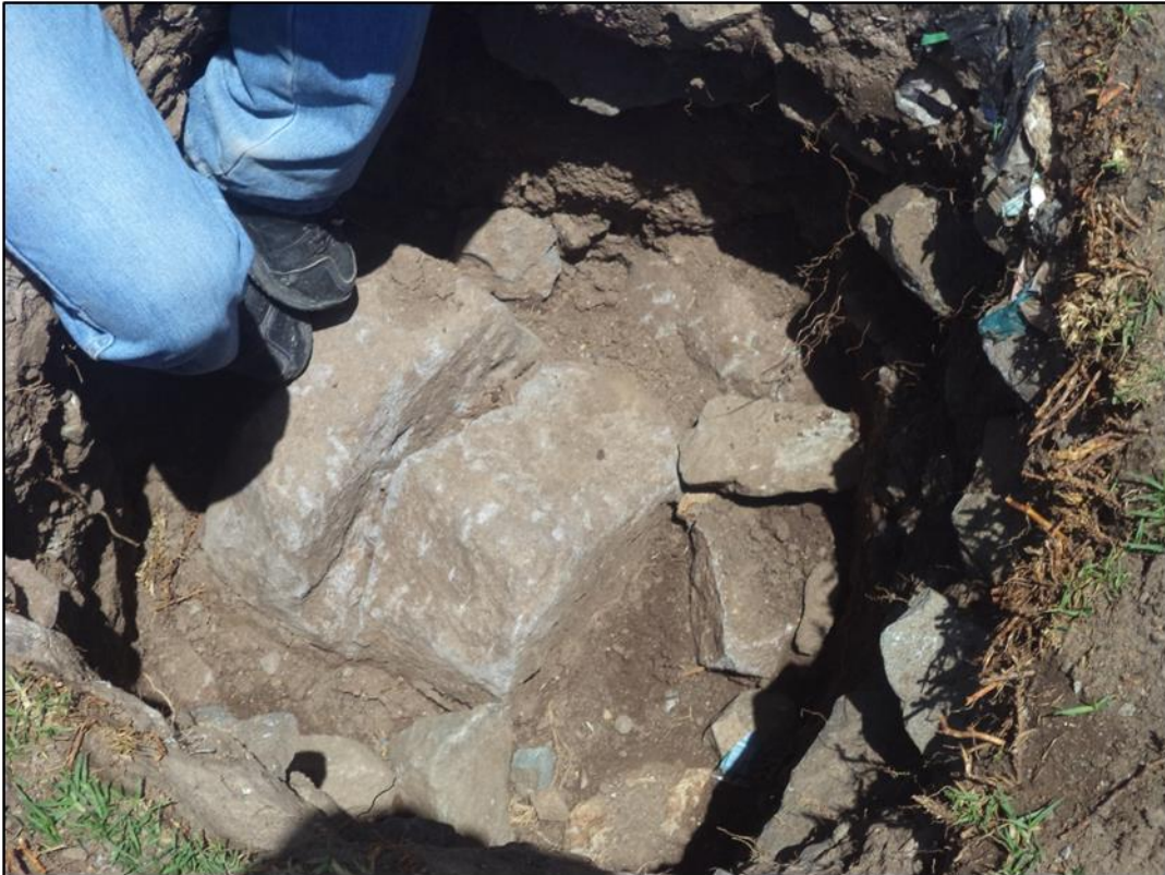
Fotografía 12. Se observa la Calicata N°3 donde se encontró un suelo gravoso.
