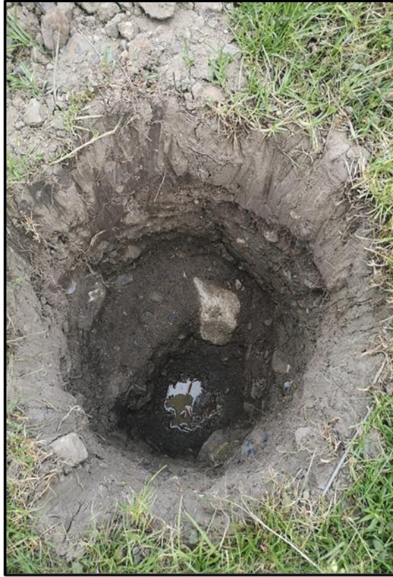
Fotografía 10. Calicata N°1 exploración a cielo abierto.
