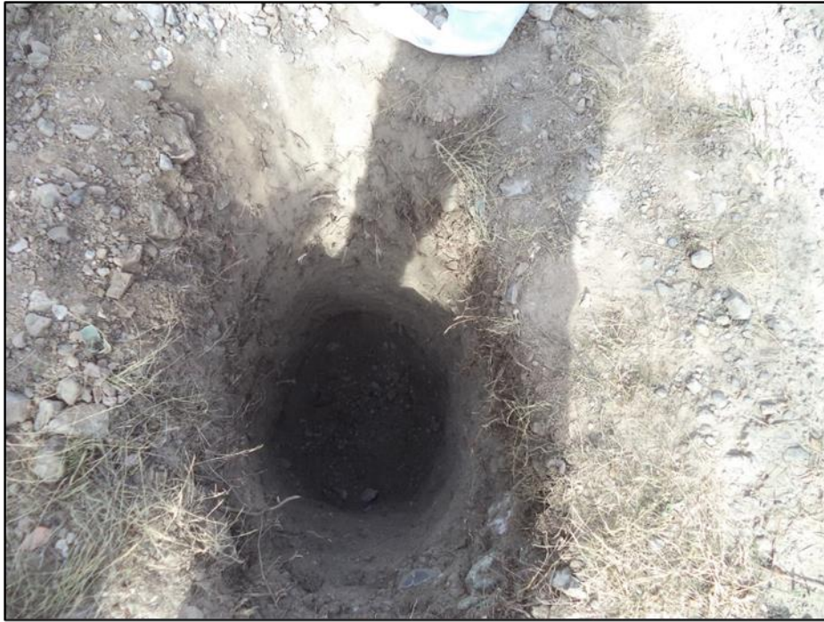
Fotografía 20. Se observa la Calicata N°15 con la profundidad necesaria y continuar con la extracción de la muestra.
