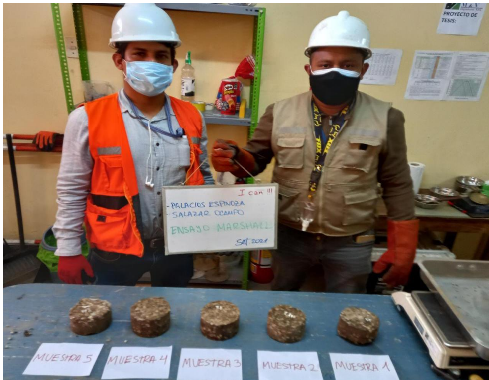
Proceso terminado del ensayo Marshall.
