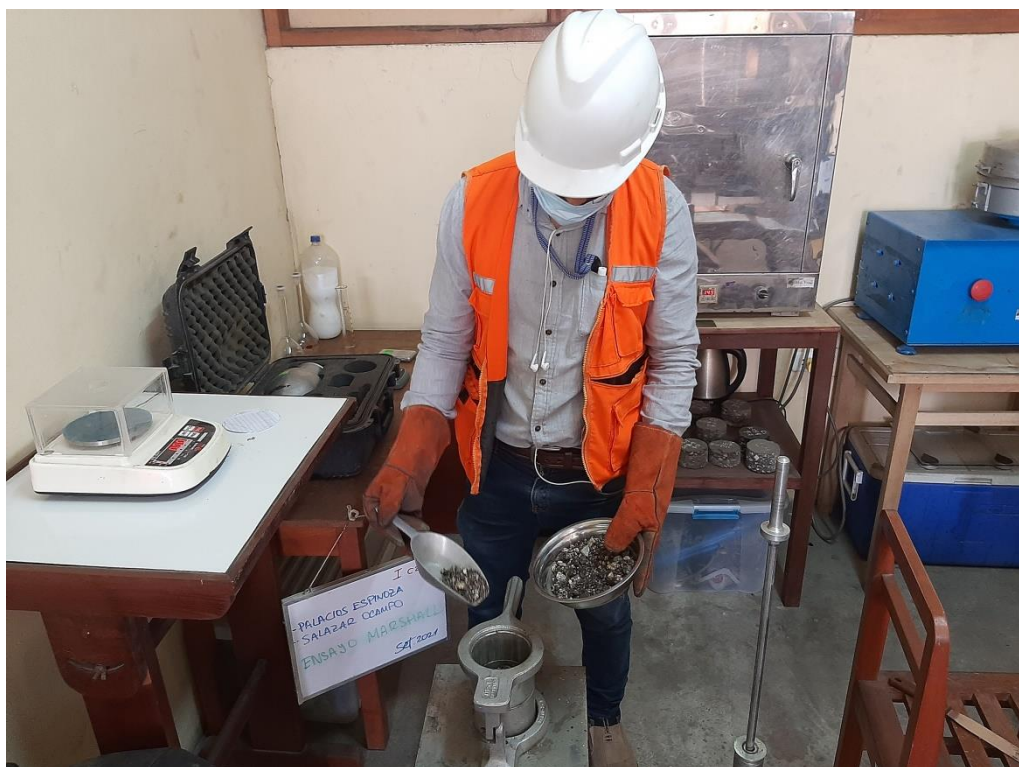
Proceso de elaboración de briquetas.
