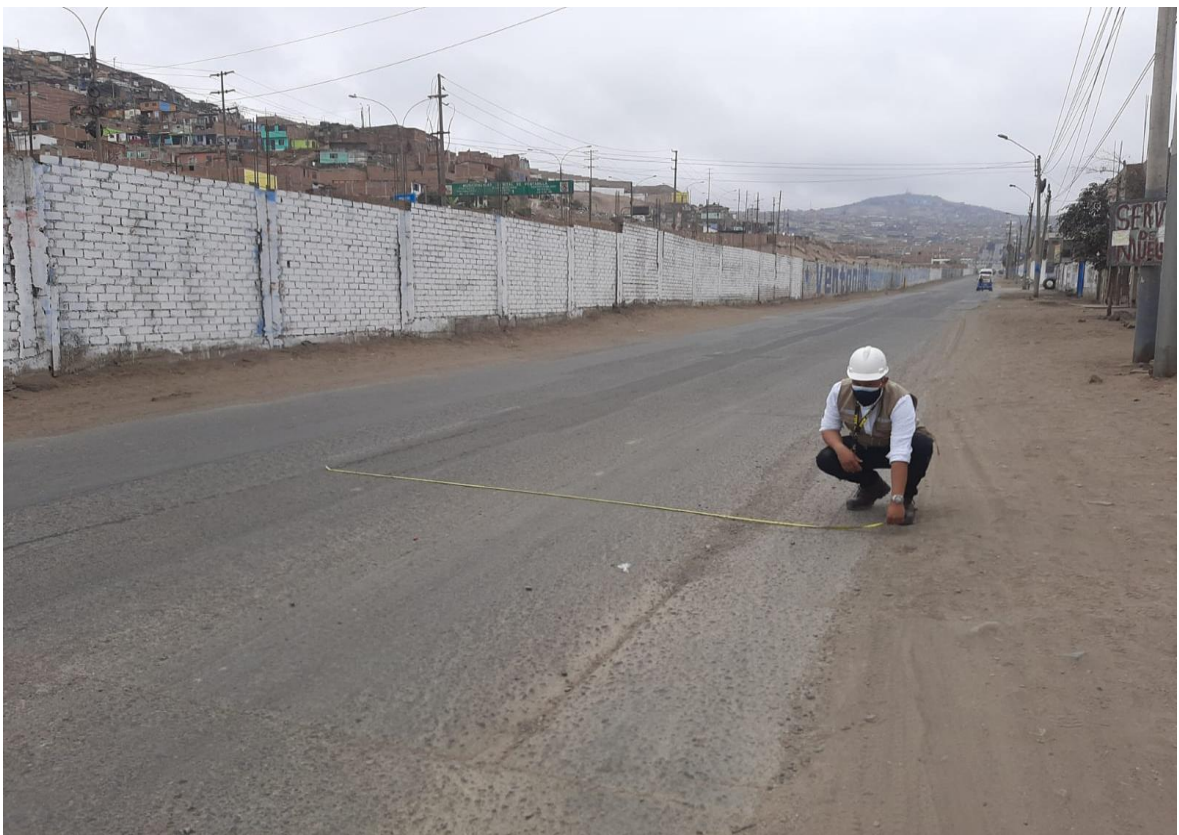
Medición de la calzada
