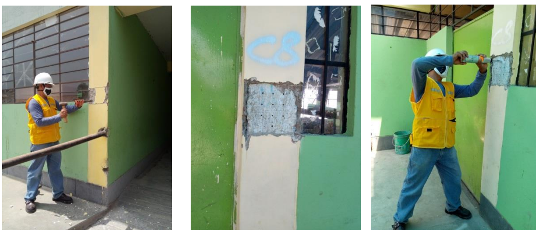
Procedimiento para el ensayo con Esclerometria. Fuente propia
