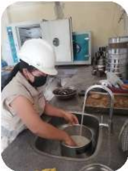
Fotografía 19. Lavado del material
