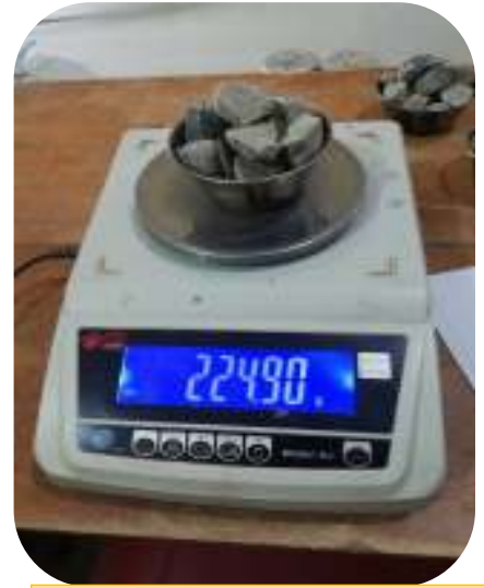
Fotografía 7. Peso del agregado grueso + tara
