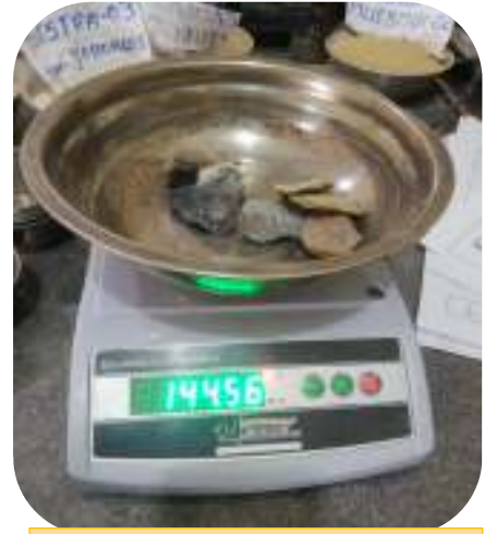
Fotografía 18. Peso del material seco
