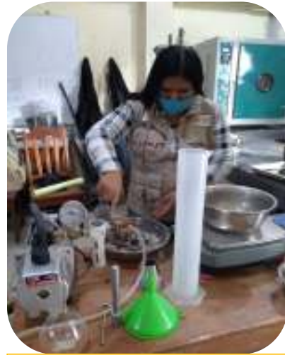
Fotografía 29. Peso del material seco
