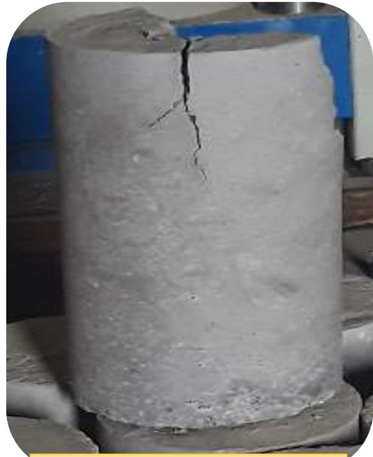
Fotografía 50. Rotura de probeta tipo 2
