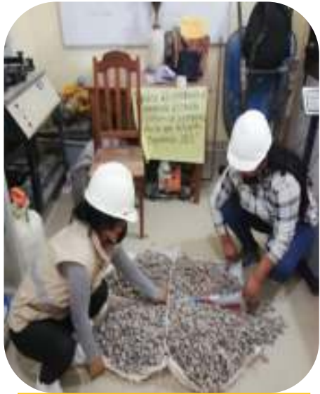
Fotografía 5. Cuarteo del material
