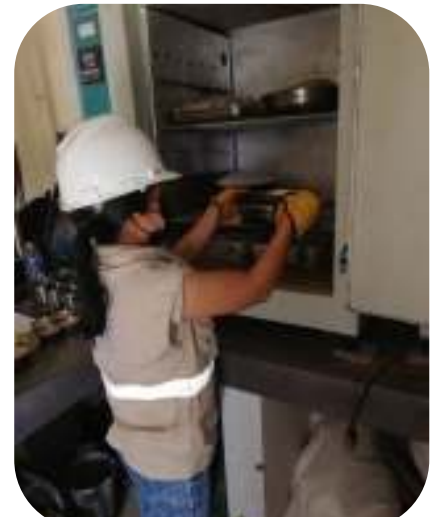
Fotografía 15. Secado del material +/- 110°C
