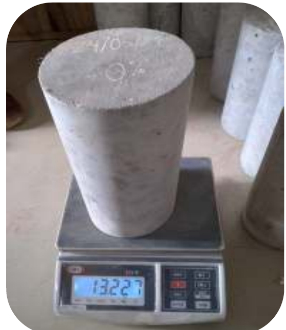
Fotografía 44. Peso de probeta al 0%
