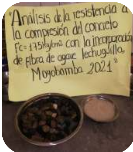
Fotografía 14. Muestra lavada previa a su colocación al horno
