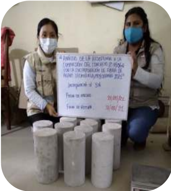
Fotografía 41. Curado de probetas al 0%, 1%, 3% y 5%
