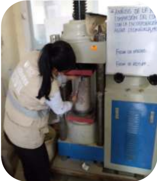
Fotografía 49. Rotura de probeta tipo 2
