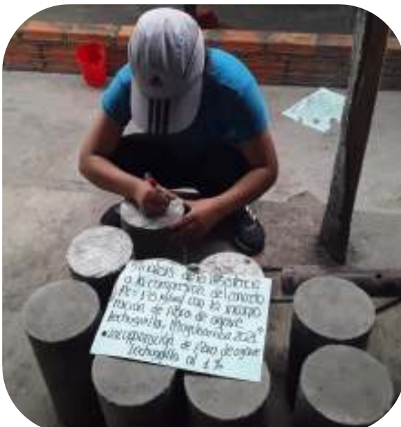
Fotografía 39. Desencofrado de probetas y fecha de muestreo
