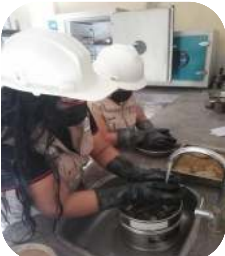
Fotografía 13. Lavado del material
