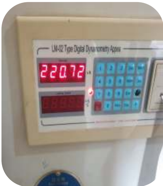
Fotografía 51. Lectura de probeta a los 7 días con 5% de fibra de agave lechuguilla
