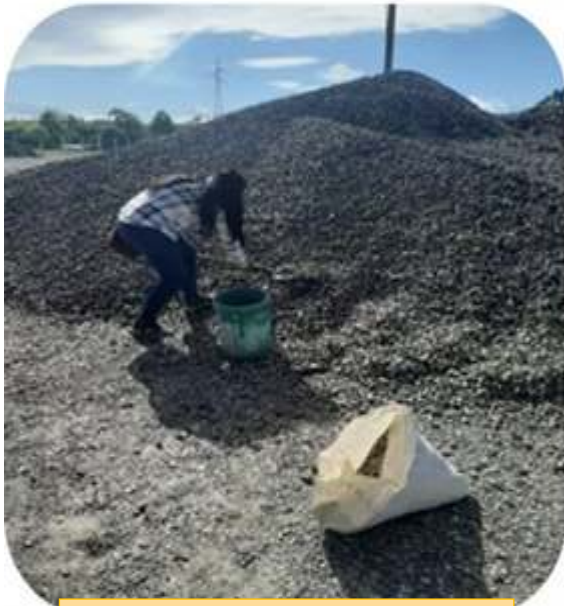
Fotografía 1. Obtención del agregado grueso
