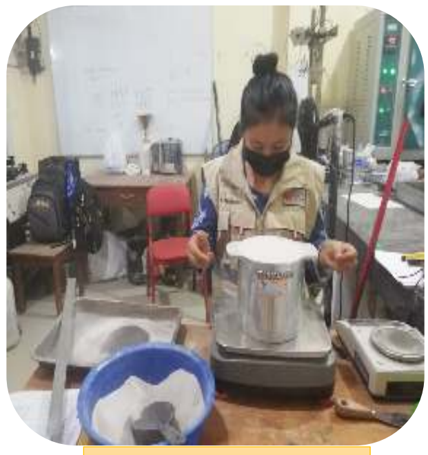
Fotografía 36. Peso del material compactado
