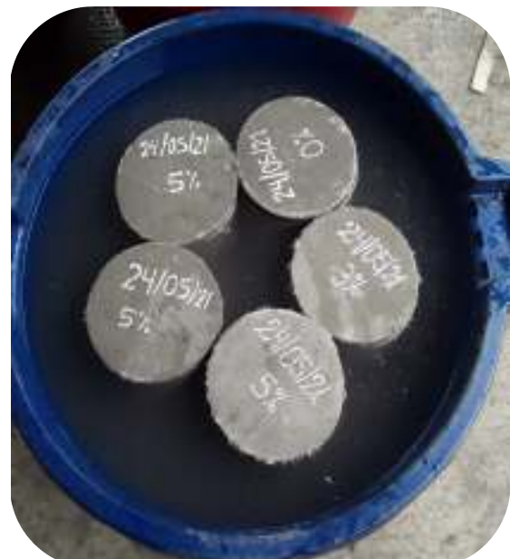
Fotografía 40. Curado de probetas al 0%, 1%, 3% y 5%
