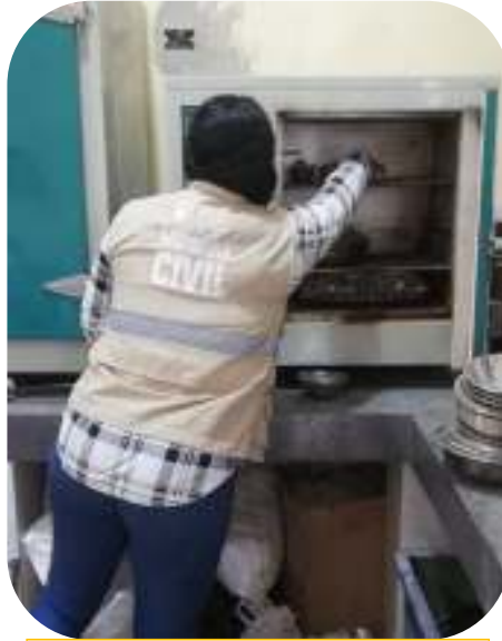
Fotografía 11. Secado del material+/- 110°C
