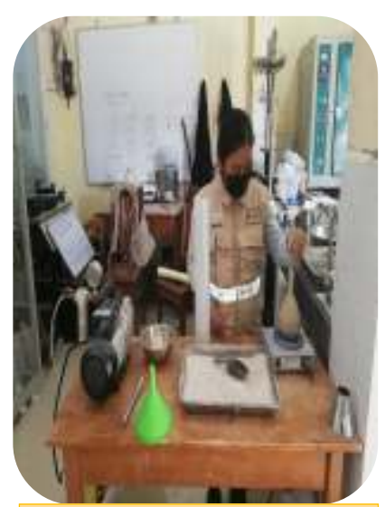
Fotografía 32. Peso de la fiola + agua + material
