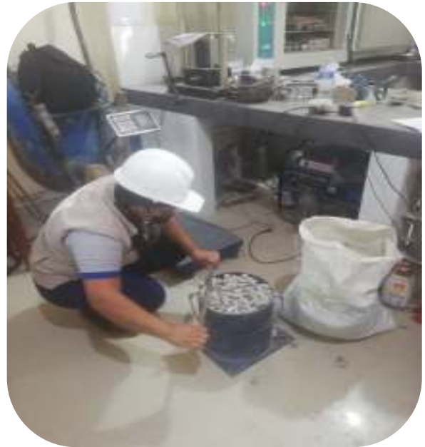
Fotografía 34. Peso del material suelto
