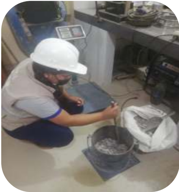
Fotografía 33. Vibración por capa con 25 golpes
