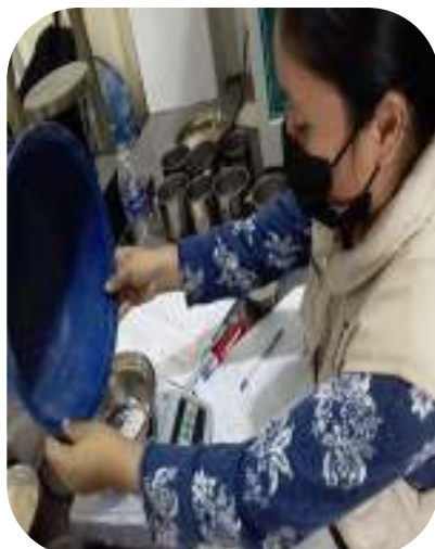
Fotografía 23. Colocación de la muestra retenida a la tara
