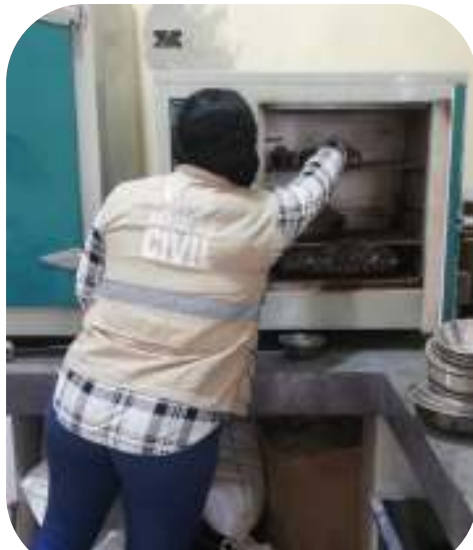
Fotografía 8. Secado del material +/- 110°C
