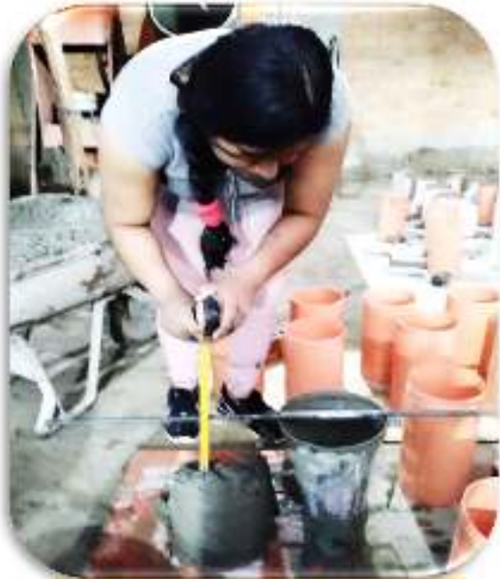
Fotografía 37. Ensayo del concreto en estado endurecido (slump) con 1% de fibra de agave lechuguilla (4")
