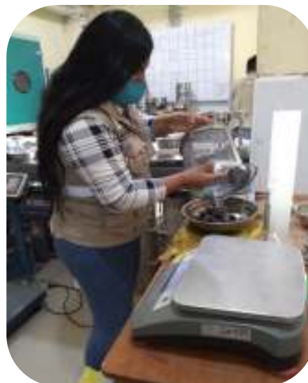
Fotografía 27. Peso del material húmedo
