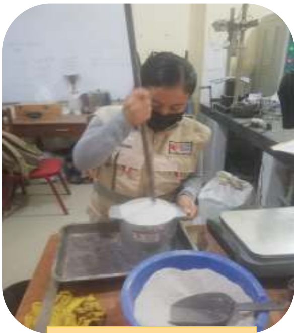
Fotografía 35. Vibración por capa con 25 golpes
