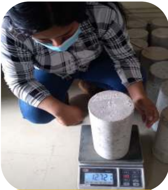
Fotografía 45. Peso de probeta al 1%
