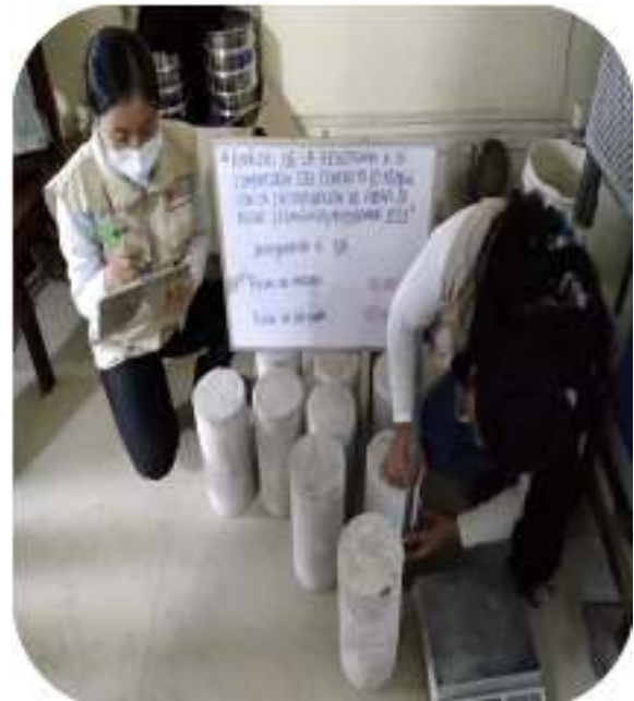
Fotografía 42. Altura de probeta (30cm)
