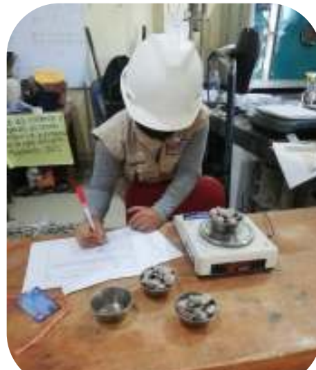
Fotografía 9. Peso del material seco
