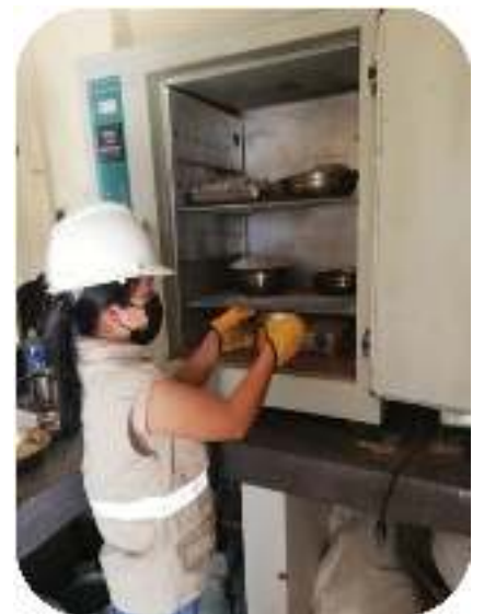
Fotografía 21. Secado del material \pm 110^\circ\text{C}
