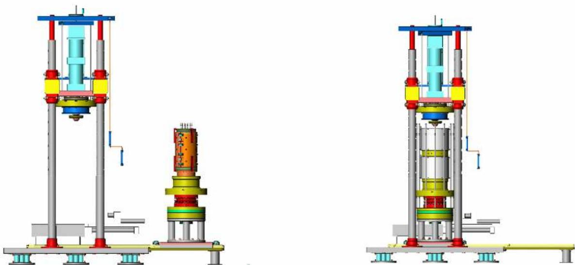
Figure III-42 : Phase de préparation de l'éprouvette et phase d'essai (Dupla *et al.*, 2007a)
