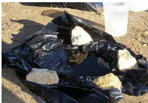
**Figure II-13 : Mesure du volume de la cavité**
