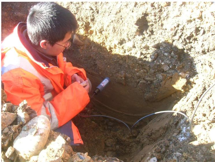
Figure II-14 : Mesure de la teneur en eau volumique par sonde Thétaprobe
