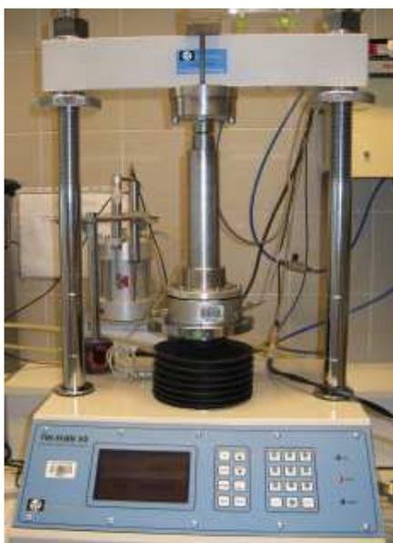
Figure III-38 : Compactage de l'échantillon
