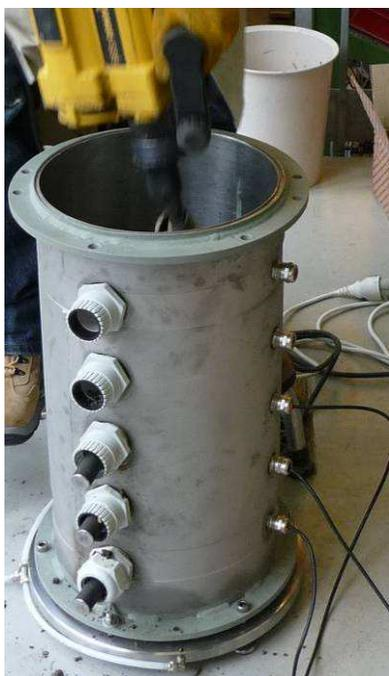
Figure III-8 : Compactage de l'échantillon
