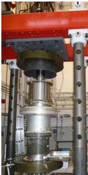
**Figure III-15 : Vérification de l'effet de la densité sur les résultats de la sonde TDR – Dispositif expérimental mis au point**
