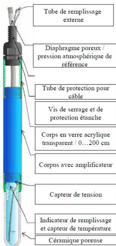
Figure III-5 : Constitution du tensiomètre T8 (T8-UMS, 2008)
