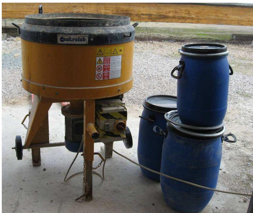
Figure III-7 : Malaxeur et bidons de stockage des matériaux
