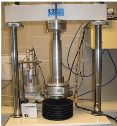
Figure III-32 : Compactage des échantillons
