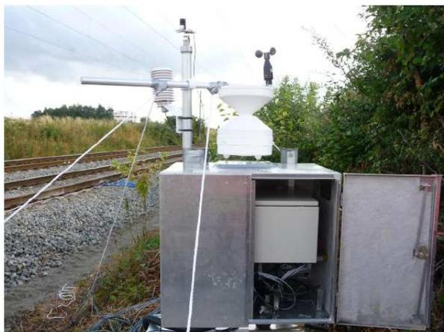
Figure VI-8 : Station météorologique et centrale d'acquisition
