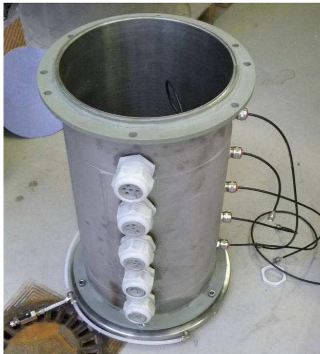
Figure III-3 : Vérification de l'étanchéité de la colonne
