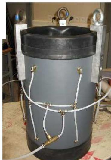
Figure III-45 : Tendeur de membrane
