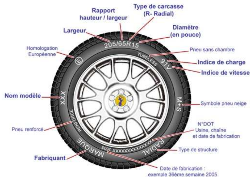
FIGURE 1.11: Constitution d'un pneumatique
